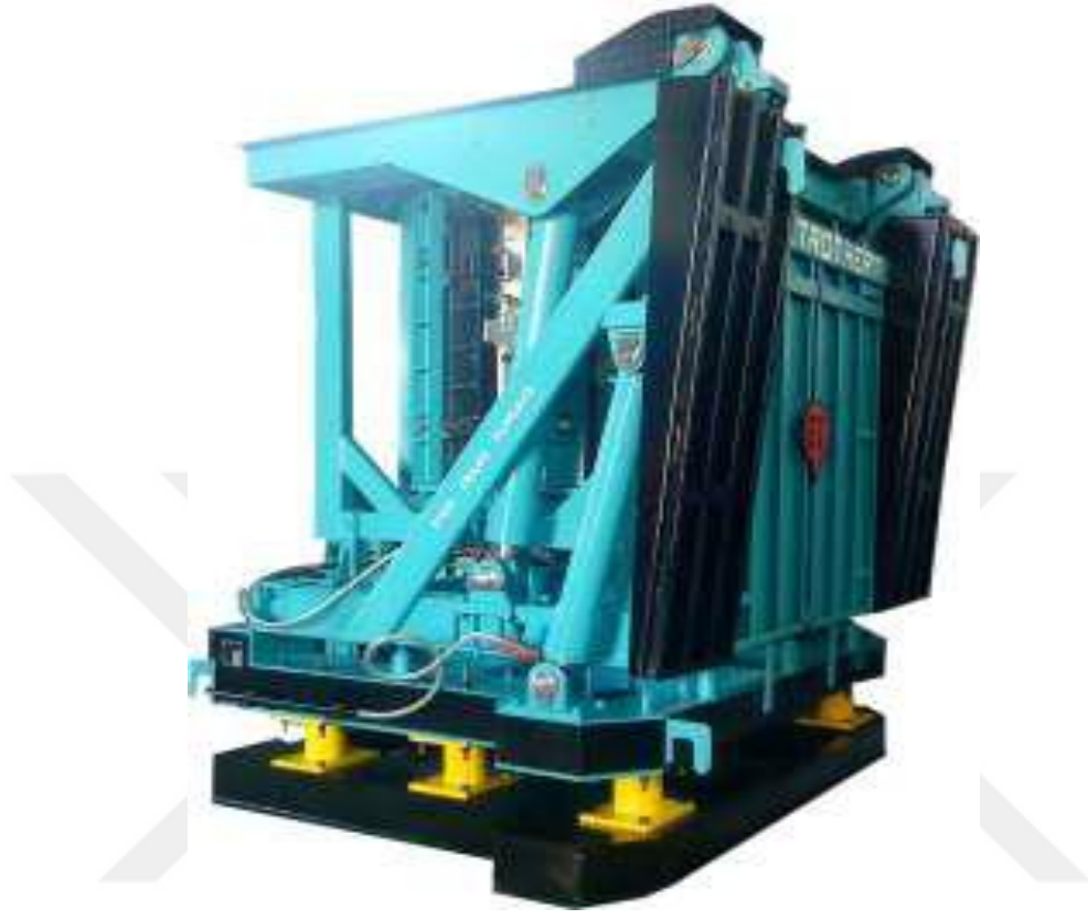
Şekil 2.7. 28 Ton indüksiyon fırını
