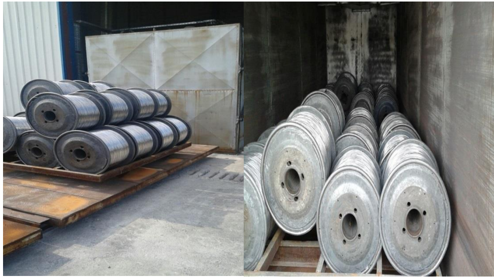
Şekil 3.20. Alüminyum tellere uygulanan ısıl işlem
