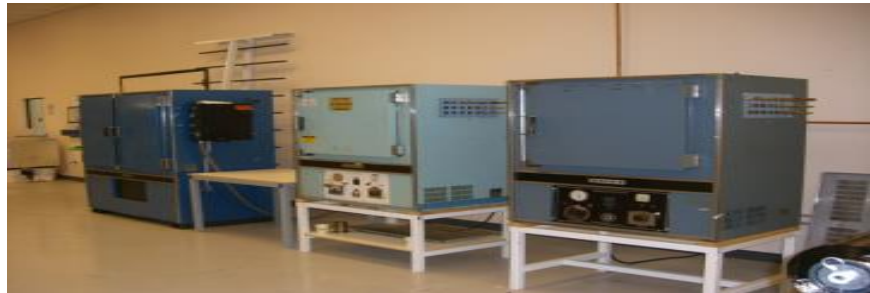
Şekil 2.10. Kompozit öz numunesi bir yıl boyunca 220°C’de fırınlanmıştır (CTC Global, 2011)
