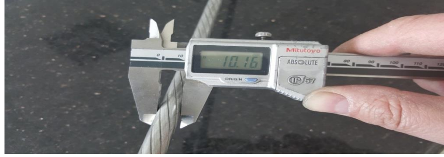
Şekil 4.19. Alt katman 8 telli tabakanın dış çapının ölçülmesi sonucu çap 10.16 mm olarak ölçülmüştür
