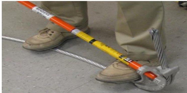
Şekil 2.8. İletken 6 inç çapında, 90 derece açıyla 10 kez bükülmüştür (CTC Global, 2011)
