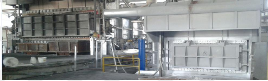
Şekil 3.6. Döküm prosesi ergime ve dinlendirme fırınları
