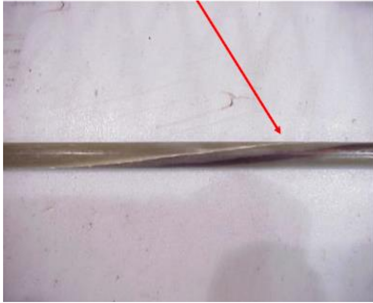
Şekil 2.12.Kompozit öze uygulanan burulma deneyi sonucu 54 tur sonunda kopma olmamıştır (CTC Global, 2011)
