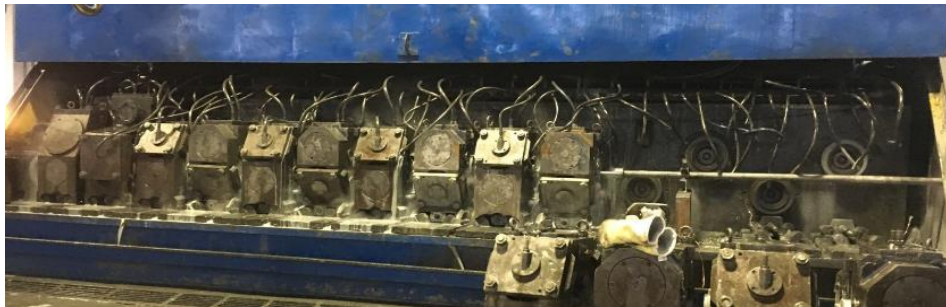
Şekil 3.8. Döküm prosesi haddeleme ünitesi
