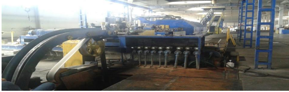
Şekil 3.7. Döküm prosesi bakır teker soğutma ünitesi ve alüminyum bara oluşumu
