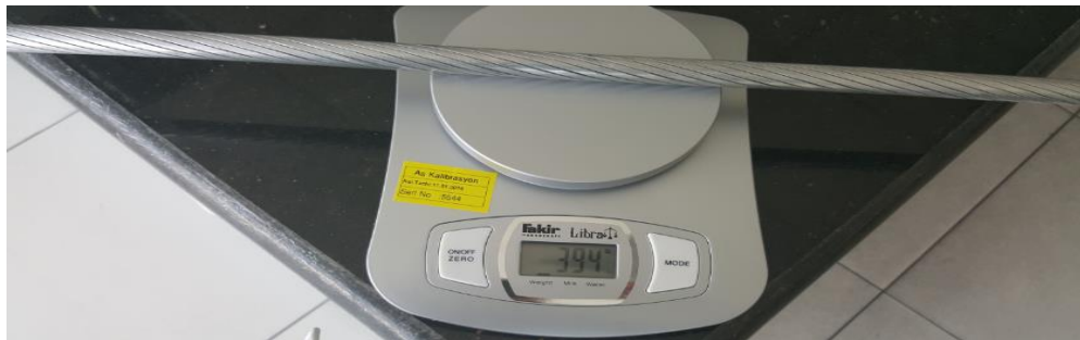
Şekil 4.22. ACCC Silvassa iletkeninin 1 metresinin ağırlığı hassas terazi yardımıyla 394 gr olarak ölçülmüştür
