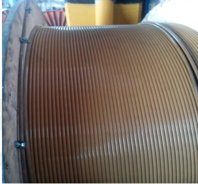
Şekil 3.5.Kompozit özün makaraya sarılmış hali
