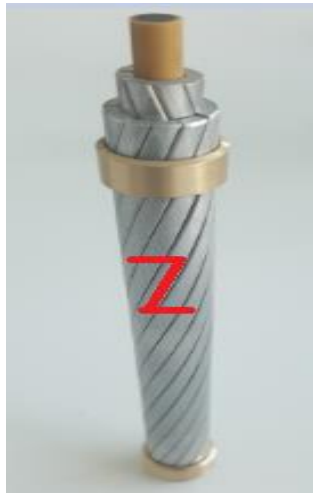
Şekil 4.11. ACCC Silvassa iletkeni üst katmanının sağ adım yönünde örüldüğünün gösterilmesi
