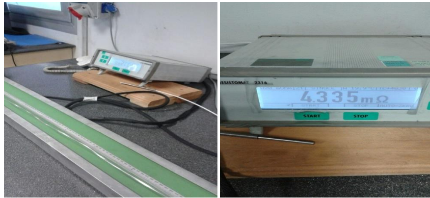
Şekil 4.29. ACCC Silvassa iletkeninde kullanılan 1 metre uzunluğunda tek telin direnci 4,333 m \Omega olarak ölçülmüştür
