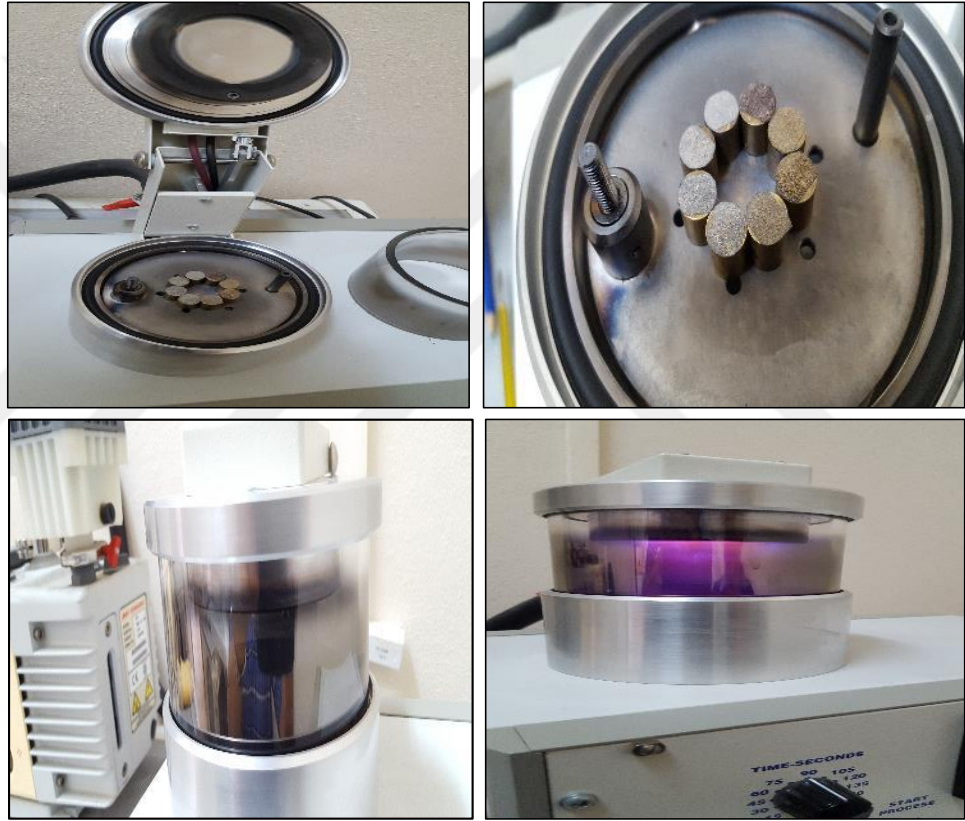
Şekil 5.1. Numunelerin Au-Pd tabakası ile kaplanması
