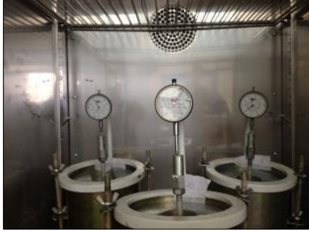
Şekil 3.37. Kapalı sistem donma-çözünme deneyi (İSTE)
