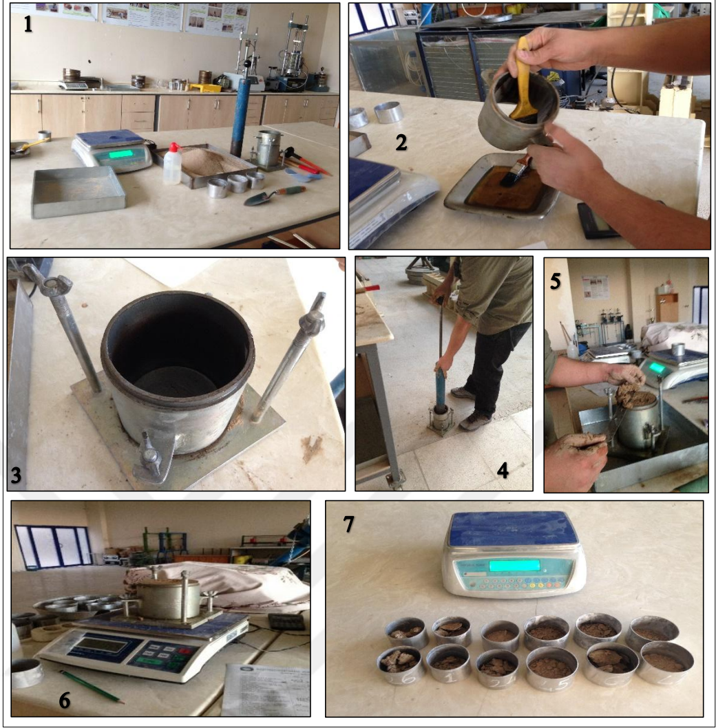
Şekil 4.18. Kompaksiyon (standart Proktor) deneyi işlem adımları
