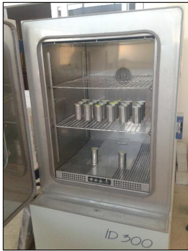
Şekil 4.9. Donma-çözünme öncesi numunelerin cihaza yerleştirilmesi.
