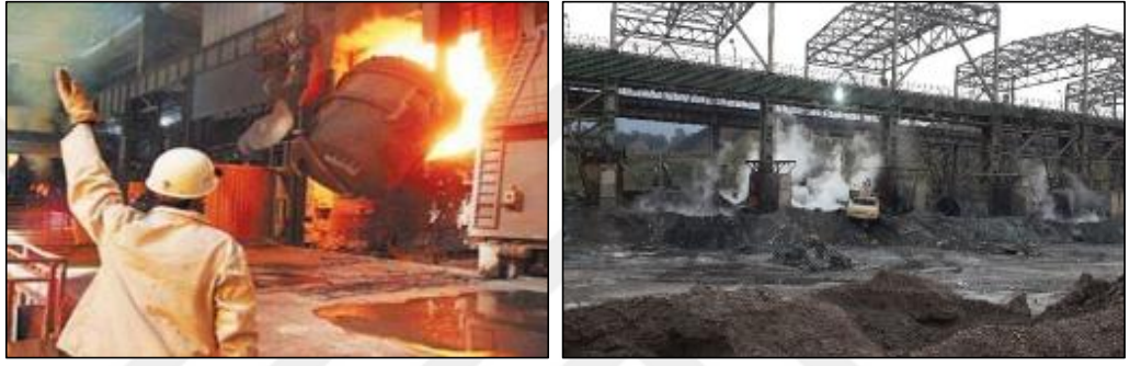
Şekil 3.2. Çelikhane sıvı ham demir şarjı ve curuf tumba tesisi
