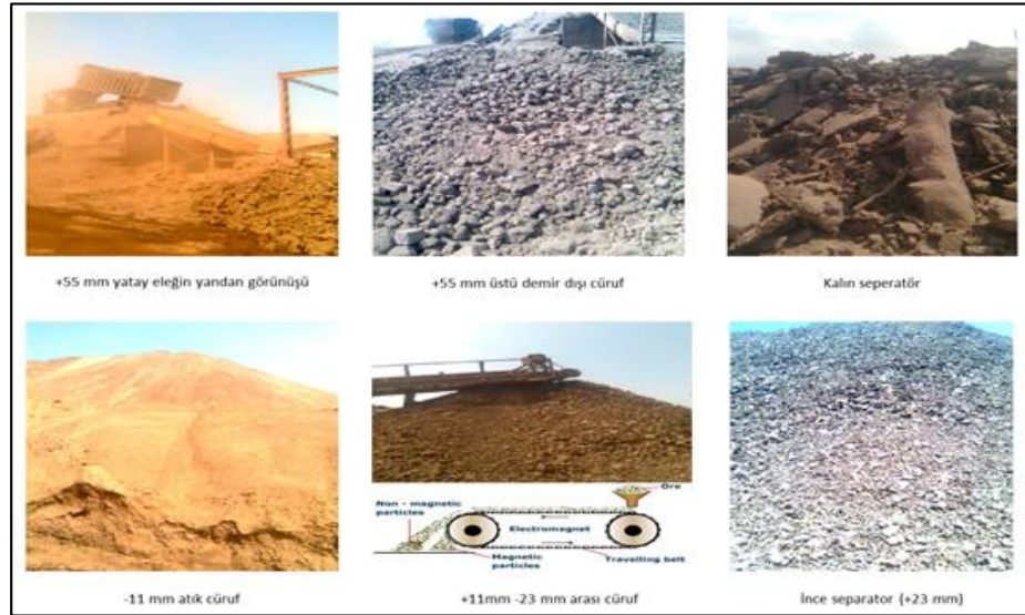
Şekil 1.2. Curuf ayrıştırma tesisi
