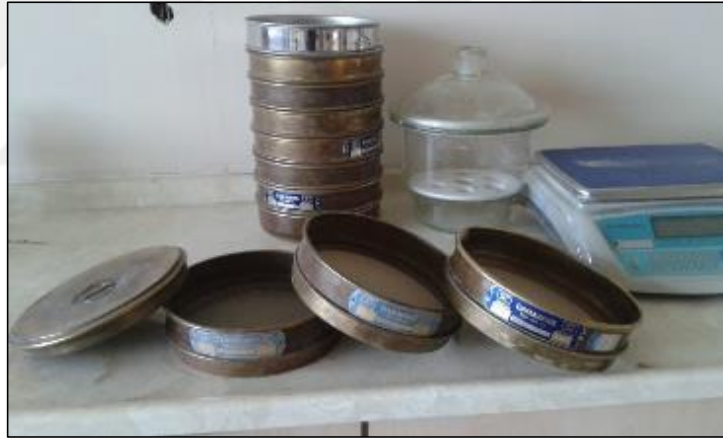
Şekil 3.25. İSTE Geoteknik laboratuvarı elek serisi
