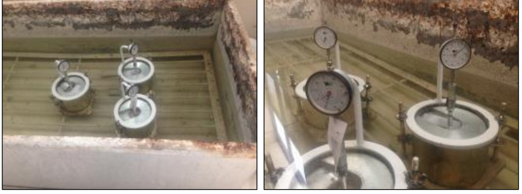
Şekil 3.36. Numunelerin suya doymun hale getirilmesi (İSTE)
