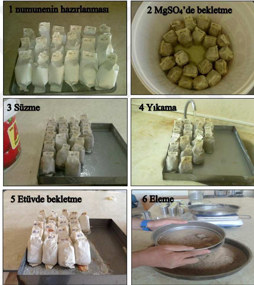
Şekil 4.15. MgSO_4 Deneyi işlem adımları.
