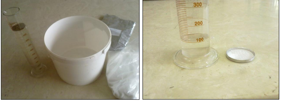
Şekil 4.14. MgSO 4 ve BrCl 2 çözeltisinin hazırlanması.
