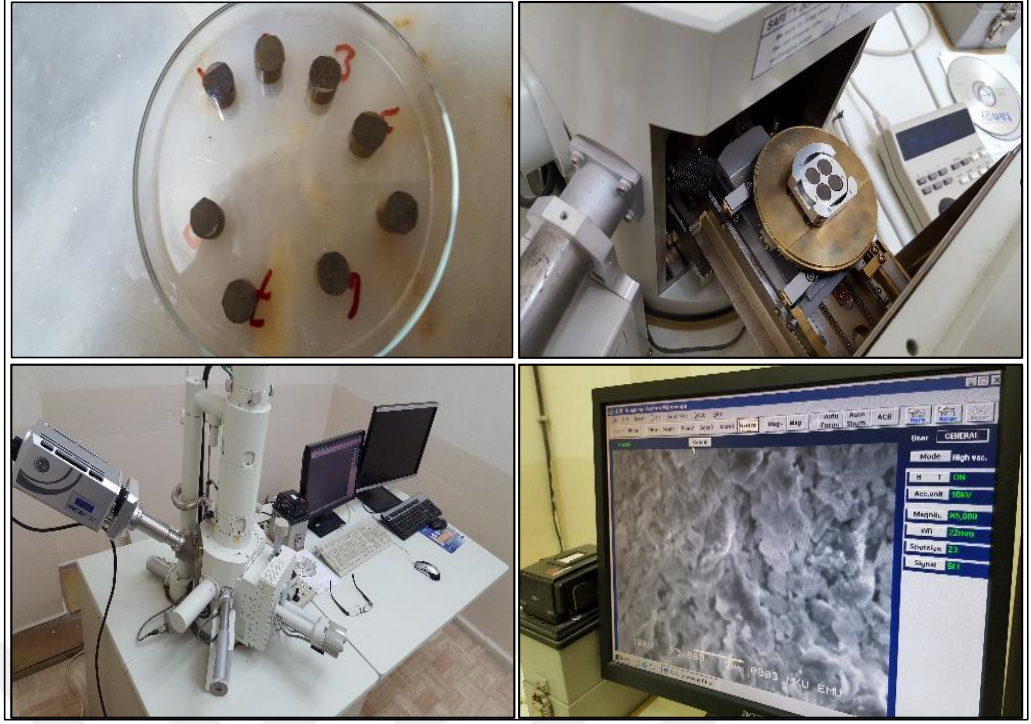
Şekil 5.2. JEOL JSM-5600LV marka SEM cihazı analiz çalışması
