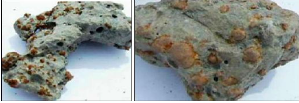
Şekil 3.8. BOF Curufu ve içindeki demir parçaları (skal)
