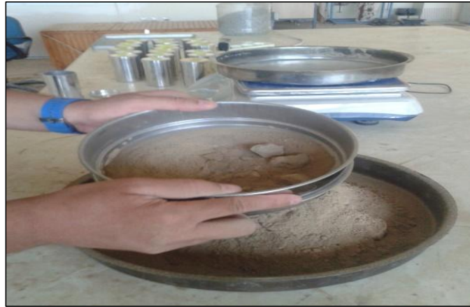
Şekil 4.10. Donma-çözünme sonrası eleme işlemi
