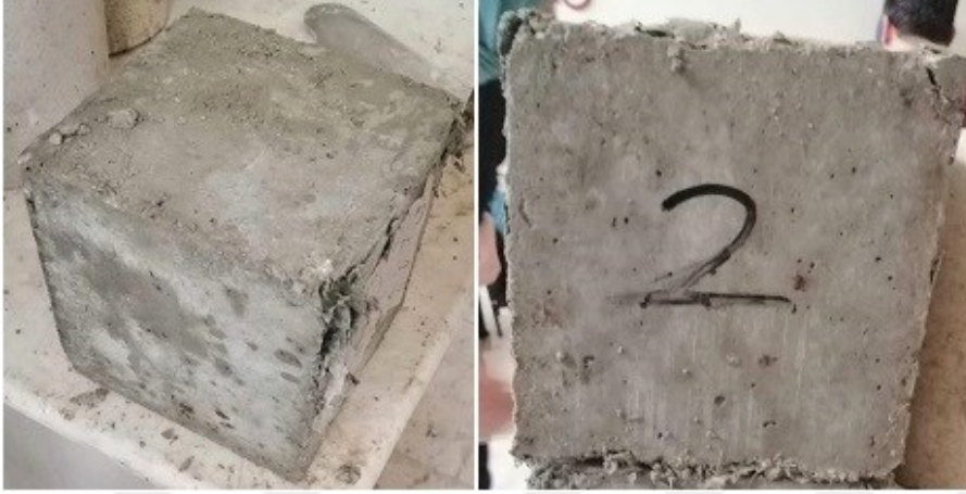
Şekil 4.2.04K betondan alınan küp numunelerin 28 günlük basınç dayanımı testi sonrası durumları
