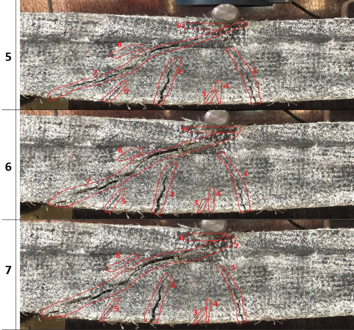
Şekil 4.38. 06K2 kirişi; 5) 13,87 ton maksimum yük taşıma kapasitesi 6) 13,87-13 ton yük aralığında, 7) 13-8 ton yük aralığında
