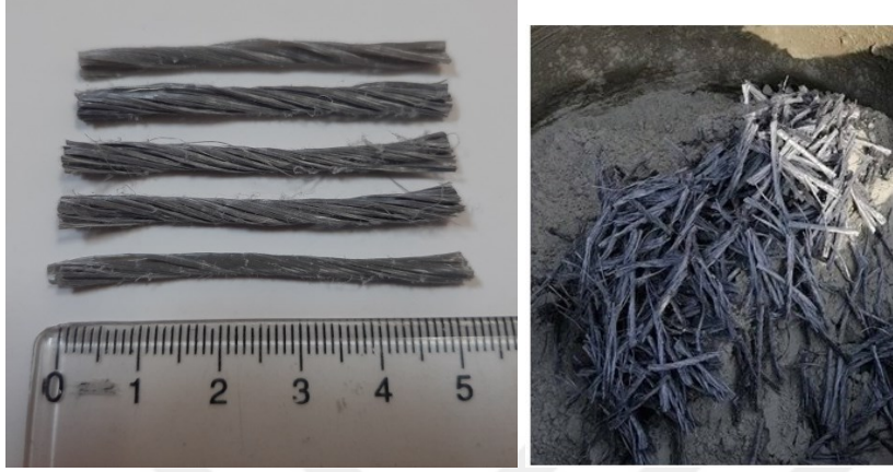
Şekil 3.2.Makro sentetik fiber lif (MSF)
