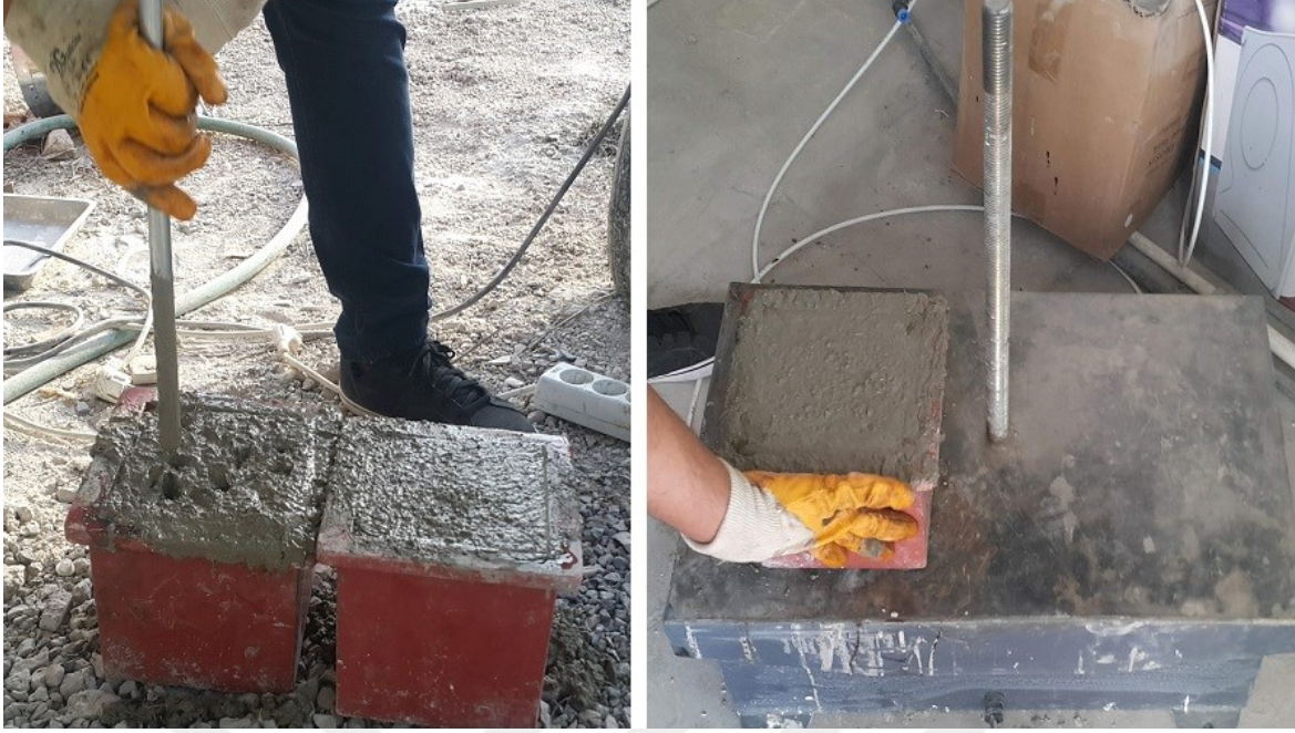
Şekil 3.8.150X150X150 mm küp numunelerin hazırlanması
