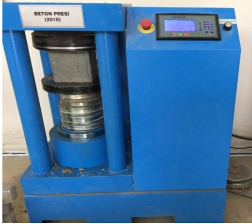
Şekil 3.10. Küp numunelerin 28 günlük basınç dayanım testi
