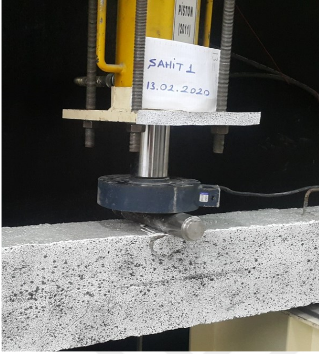
Şekil 3.20. Yük hücresinin kiriş üzerine yerleştirilmesi
