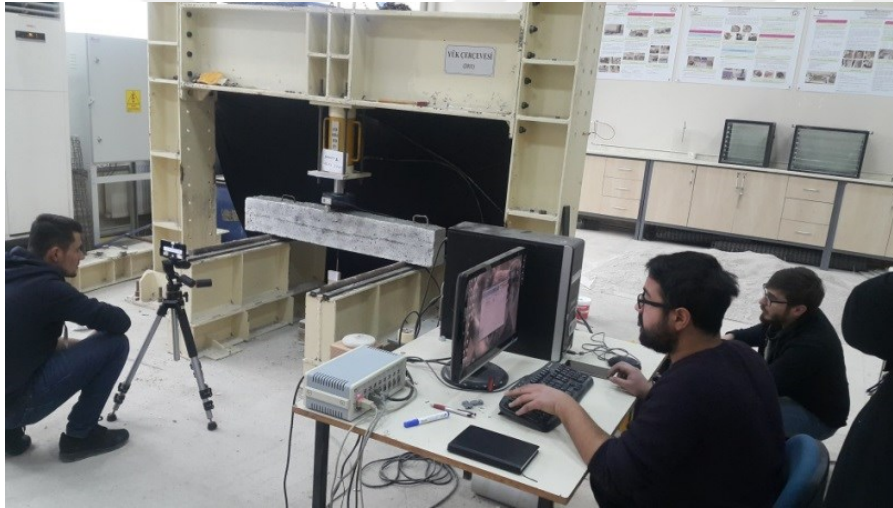
Şekil 3.22. Üç noktalı yükleme deneyi ve verilerin toplanması
