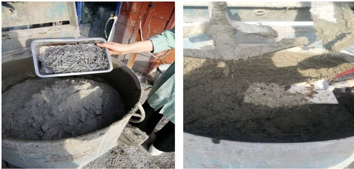
Şekil 3.7. Beton karışımına MSF eklenmesi
