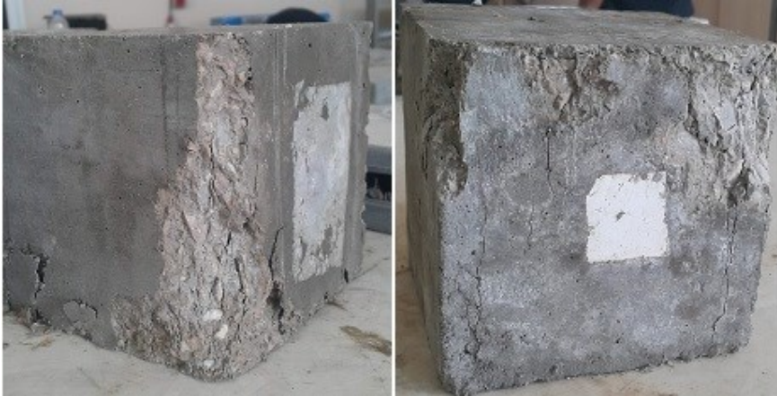
Şekil 4.1.Şahit betondan alınan küp numunelerin 28 günlük basınç dayanımı testi sonrası durumları
