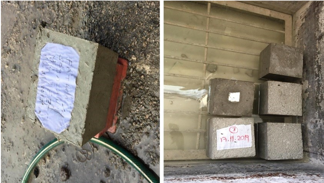
Şekil 3.9.Küp numunelerin kalıptan çıkarılıp kür havuzuna bırakılması
