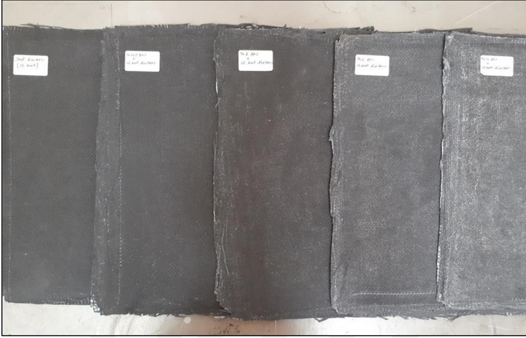
Resim 4.2. Farklı oranlarda katkılandırma yapılmış kompozit plakaların görüntüleri
