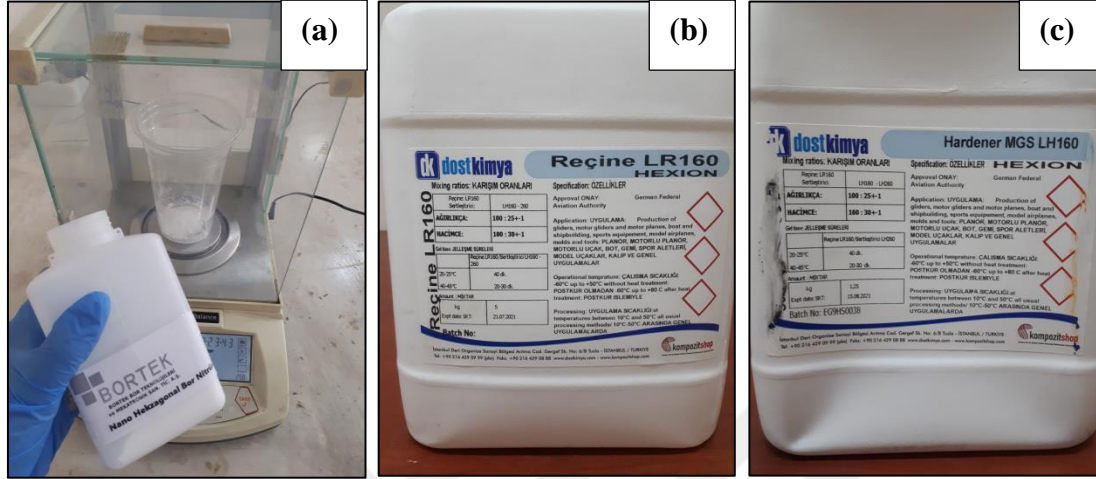
Resim 4.1. (a) hegzagonal nano bor nitrür, (b) epoksi, (c) sertleştirici
