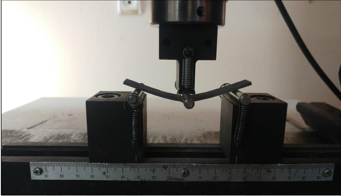
Resim 4.7. Üç noktalı eğilme deneyinin uygulanması
