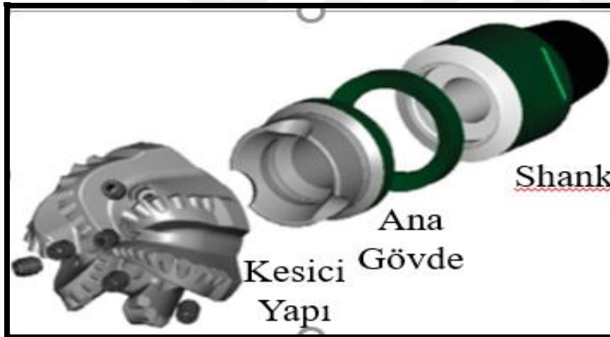
Şekil 2.21. Sabit başlı (fixed cutter) matkap yapısı [1]
