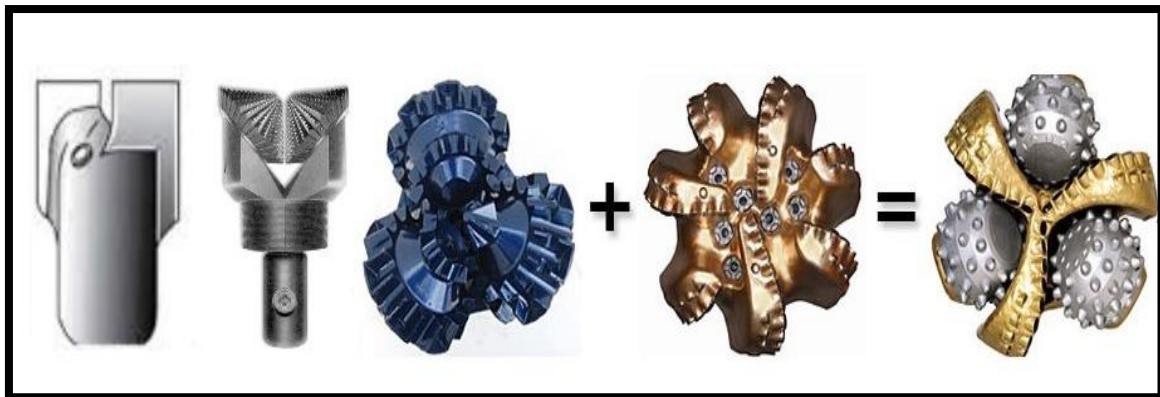
Şekil 2.11. Matkapların süreç içindeki gelişimi [7]
