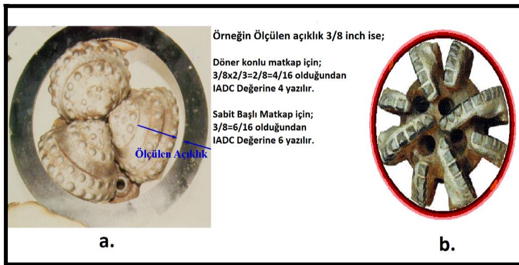
Şekil 2.19. Döner konlu (a) ve sabit başlı (b) matkaplar için çap aşınması ölçümü ve hesabı [35, 36]
