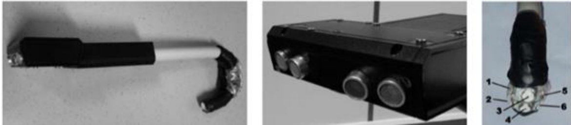
Şekil 2.4. Engel algılayan baston sistemi [7]
