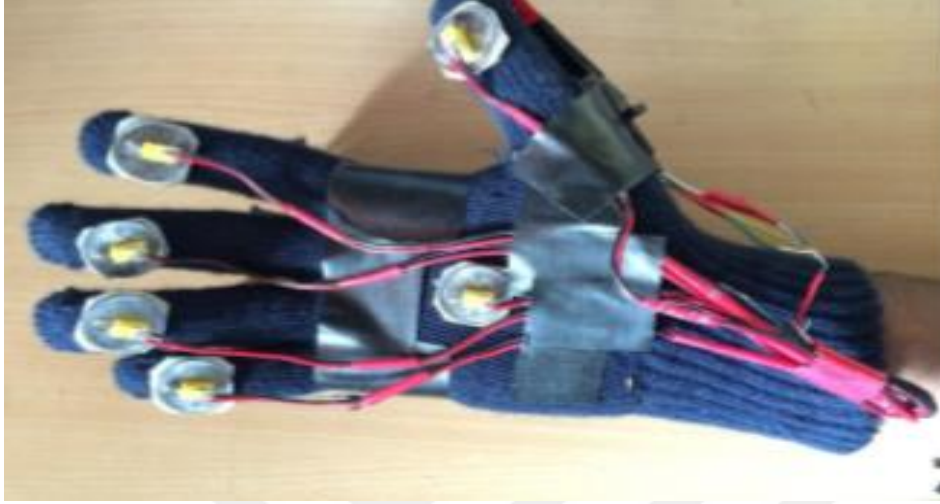
Şekil 2.9. Görme engelliler için slot sensörleri ve titreşim motorları kullanarak düşük maliyetli gerçek zamanlı iletişim kuran Braille eldiveni [23]
