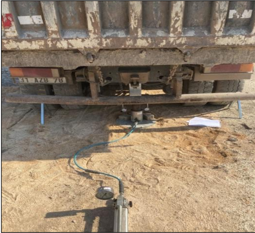
Resim 4.2. Plaka yükleme deney düzeneđi
