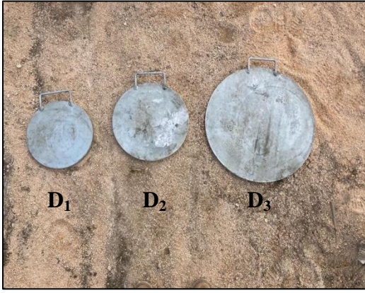
Resim 4.7. Dairesel kesitli model temeller Resim 4.8. Kare kesitli model temeller
