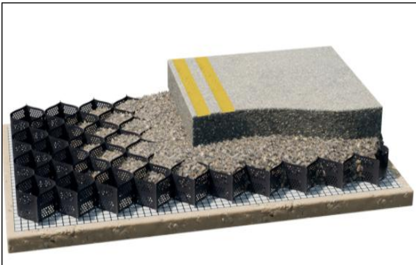
Resim 3.5. Geohücre ile karayolu zemin stabilitesi sağlanması (İnternet 4)
