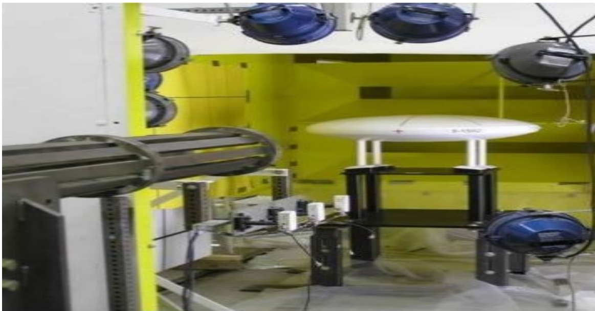
Resim 1.4. Bir anten bileşeninin FAA kuş çarpması sertifikasyon testi [20-21].
