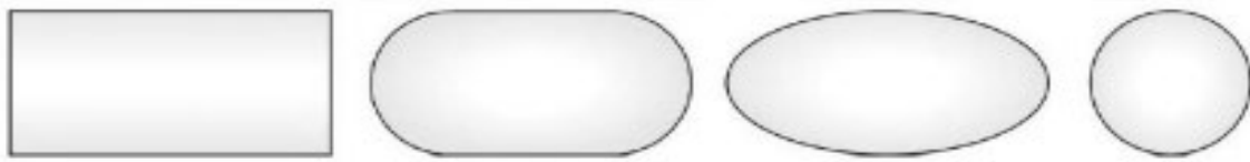
Resim 3.6. Testlerde kullanılan farklı kuş geometrileri [21].
