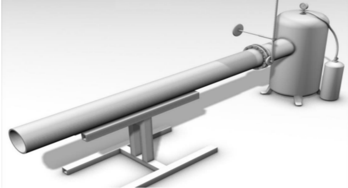
Resim 1.5. Kuş çarpması sertifikasyon testlerinde kullanılan kuş bazukası sistemi modeli [24].
