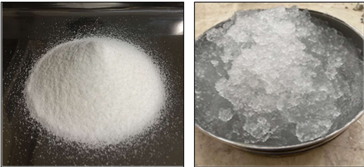
Şekil 1. 11. Sodyum poliakrilat'ın bünyesine almış olduğu su sonucu hacimsel değişimi
