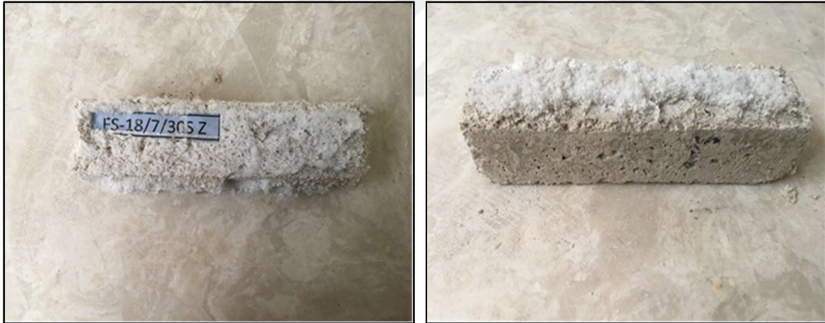
Şekil 3. 16. Sülfat numunelerinin yüzeyinde oluşan beyaz tortular
