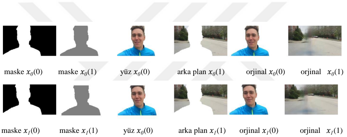
Resim 3.3 Özçekim stabilizasyon metod özeti. X(0) :video karesinin ön plan kısmı X(1) :video karesinin arka plan kısım
