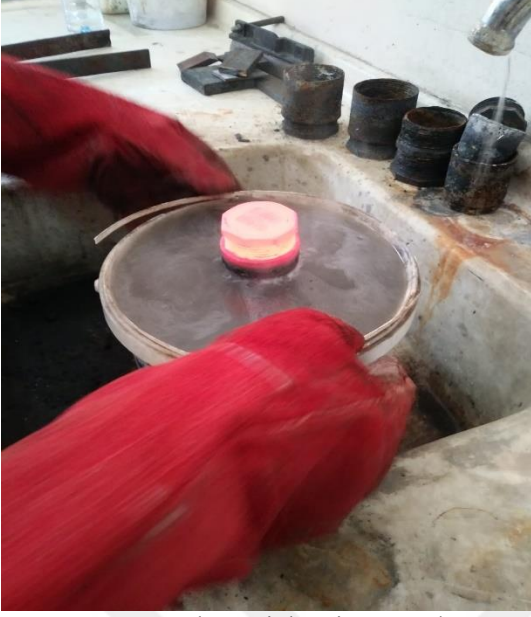
Resim 5.4. Borlama işlemi sonunda soğumaya bırakılan potanın görüntüsü
