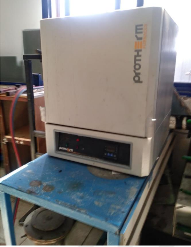
Resim 5.2. Borlama işleminin gerçekleştirildiği fırın
