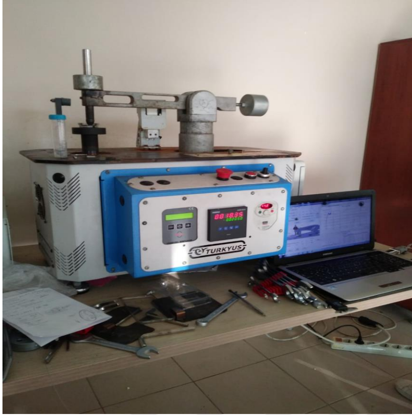
Resim 5.7. Aşınma test düzeneği
