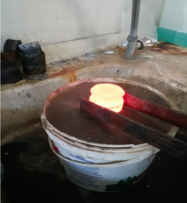
Resim 5.3. 4 saat fırında bekletilen potaların işlem sonunda fırın dışına alınma görüntüsü
