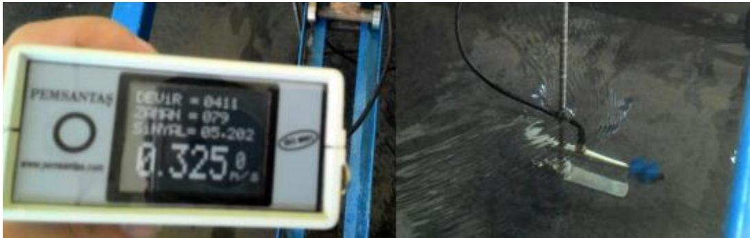
Resim 3.6. Muline cihazı ve ölçüm durumu (Gemici, 2015).
