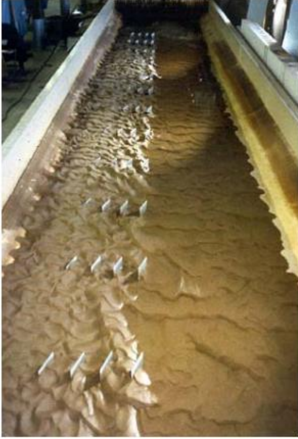
Resim 1.3. Batık kanatların suyun hızına etkisi (Odgaard, 2009)
