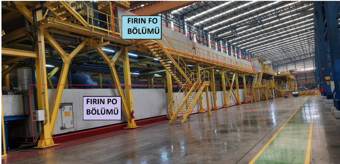
Resim 4.1. MMK Metalurji'de boyama hattı kurutma fırınının gerçek görünümü
