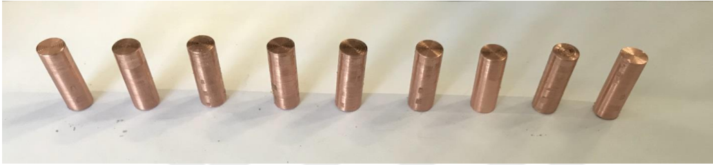
Şekil 4.2. EDM için hazırlanan tornalanmış bakır elektrotlar
