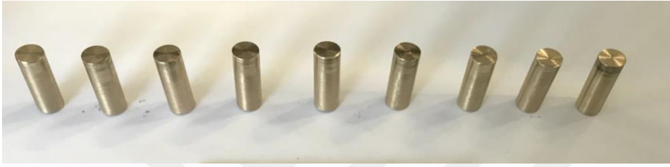
Şekil 4.3. EDM için hazırlanan tornalanmış pirinç elektrotlar
