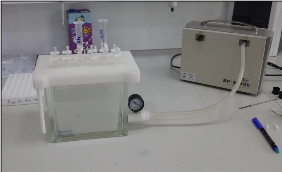
Resim 3.6 Örneklerin vakum manifoldu kullanılarak katı faz ekstraksiyon kartuşundan geçirilmesi işlemi (Orijinal)
