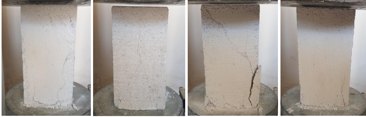
Şekil 3.7. 10x10x20 cm gazbeton numuneleri
