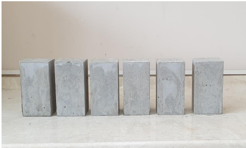
Şekil 3.3. Yapıştırıcı harç numuneleri
