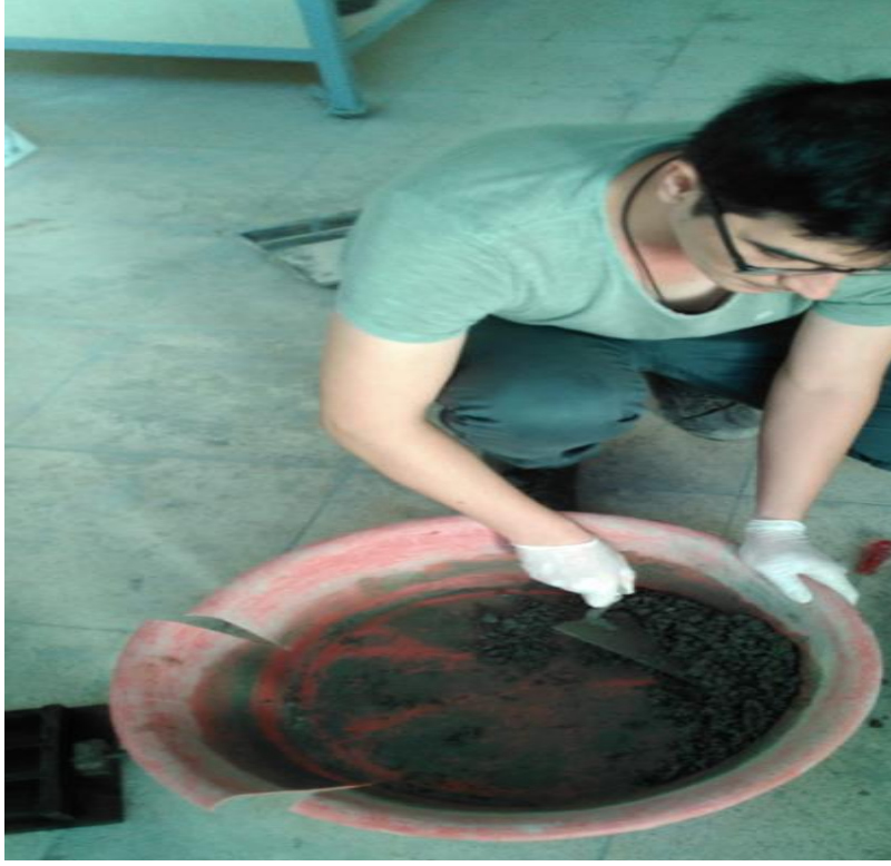
Resim 3.5. Çimentolu beton harcının malla yardımı ile karılması
