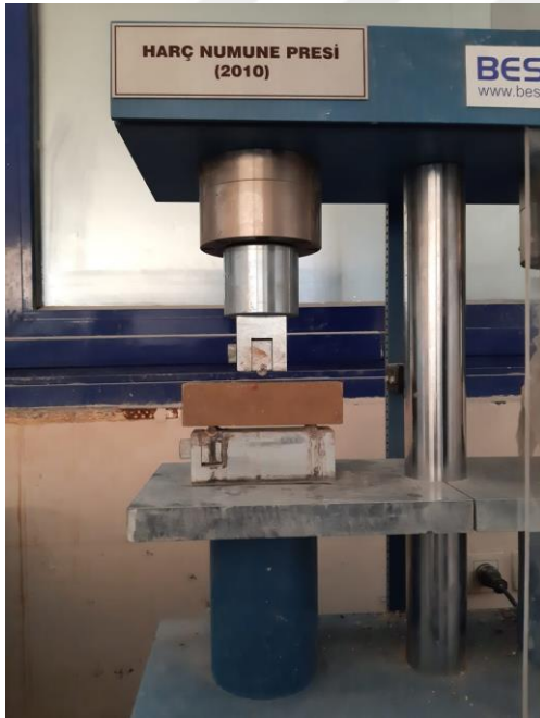
Resim 3.14. Polimer betonun eğilme deneyi esnasındaki fotoğrafı ve basınç deneyi düzeneği
