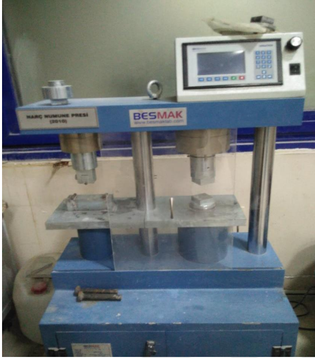
Resim 3.13. Besmak marka harç numune presi fotoğrafı
