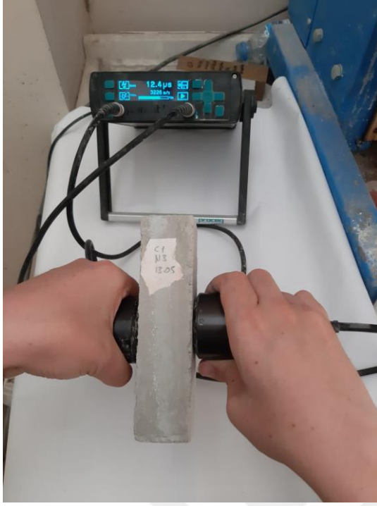
Resim 3.15. Çimento hamurunun ultrases geçiş hızı deneyi esnasındaki fotoğrafı.
