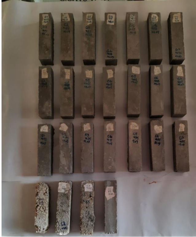
Resim 3.8. 7 farklı granülometri ve 4 farklı agrega ağırlık yüzdesine sahip çimentolu beton numuneleri
