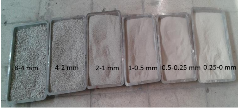
Resim 3.1. 0,25 mm ile 0,8 mm'lik eleklerden geçen agregaların sınıflandırılması
