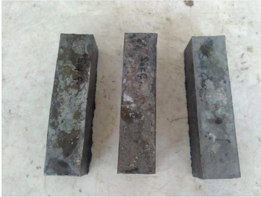
Resim 3.7. Çimento hamuru numuneleri
