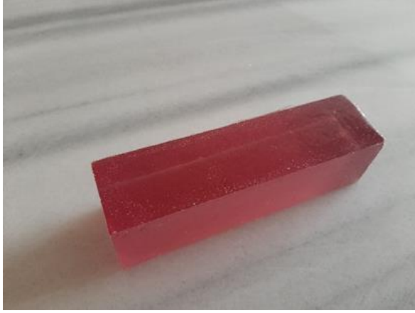
Resim 3.9. Agregasız polimer beton numunesi
