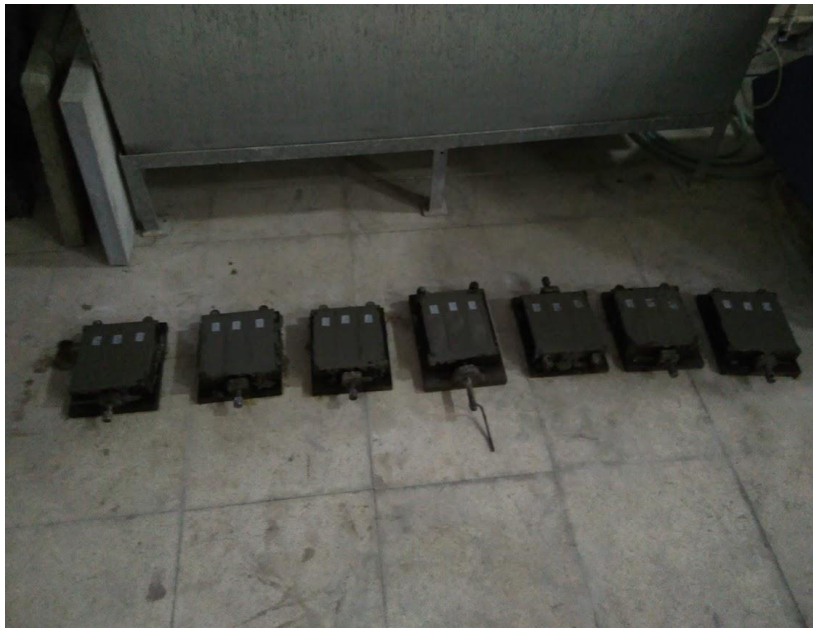
Resim 3.6. Demir harç numune kalıplarındaki çimentolu beton numuneleri
