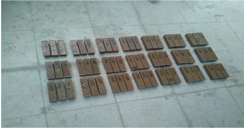
Resim 3.10. 7 Farklı granülometri ve 4 farklı agrega ağırlık yüzdesine sahip polimer beton numuneleri
