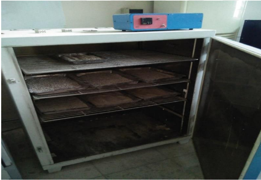
Resim 3.3. Kırma taşların nemini alması için kullanılan etüv.
