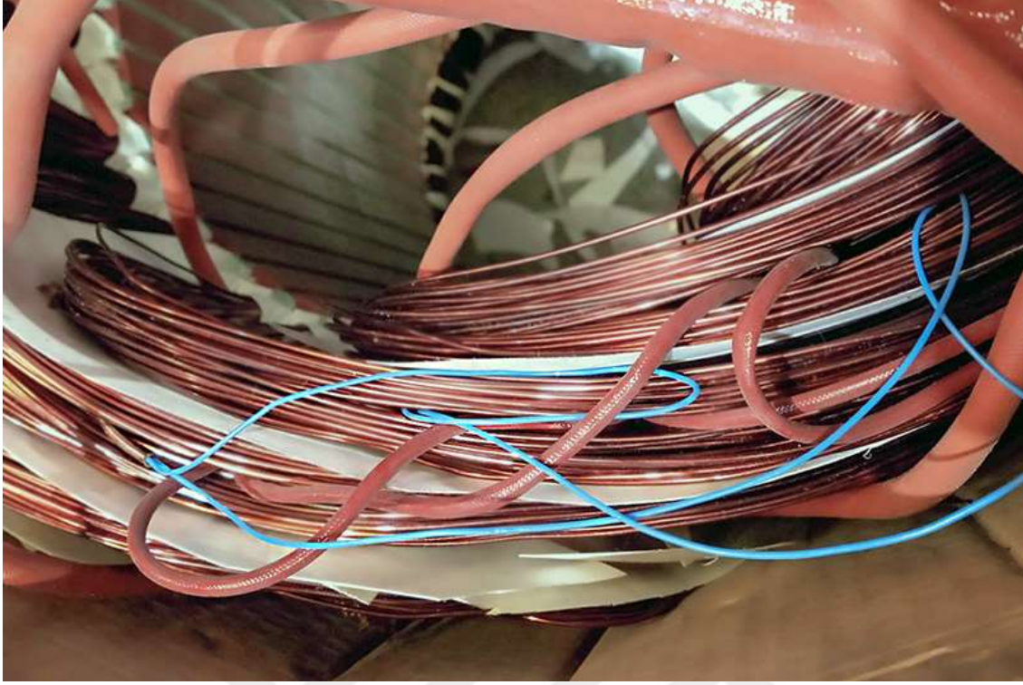
Resim 3.11. Motor sargıları arasına PT100 yerleştirilmesi
