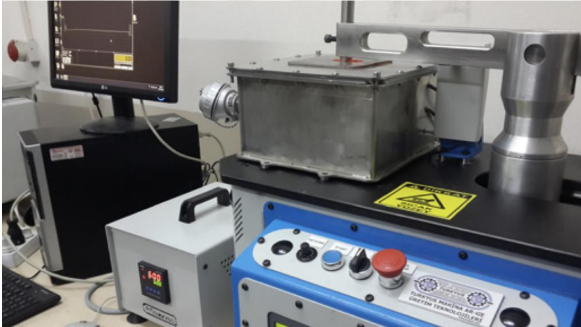
Şekil 5.7. Deneilerde kullanılan ball-on disk aşınma test cihazının görünümü.
