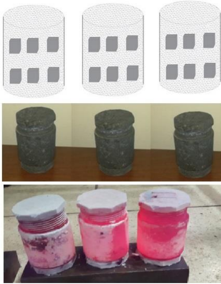
Şekil 5.2. Numunelerin potalara yerleşimi ve fırından alınıp havada soğumaya bırakılması
