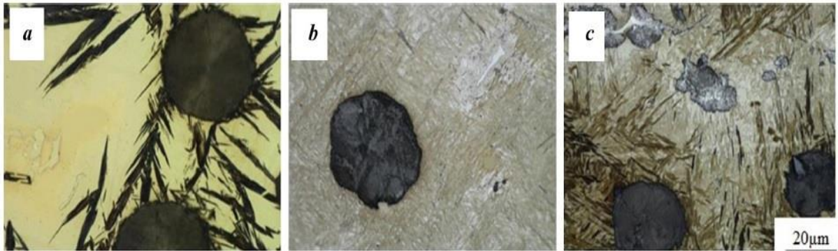
Şekil 2.15. Östenitik dökme demirler içerisinde var olması muhtemel yapıların optik mikroskop mikroyapı görüntüleri a) Östenit, martenzit, b) asiküler ferrit, kalıntı östenit c) iğneli ferrit, perlit ve kalıntı östenit [84].
