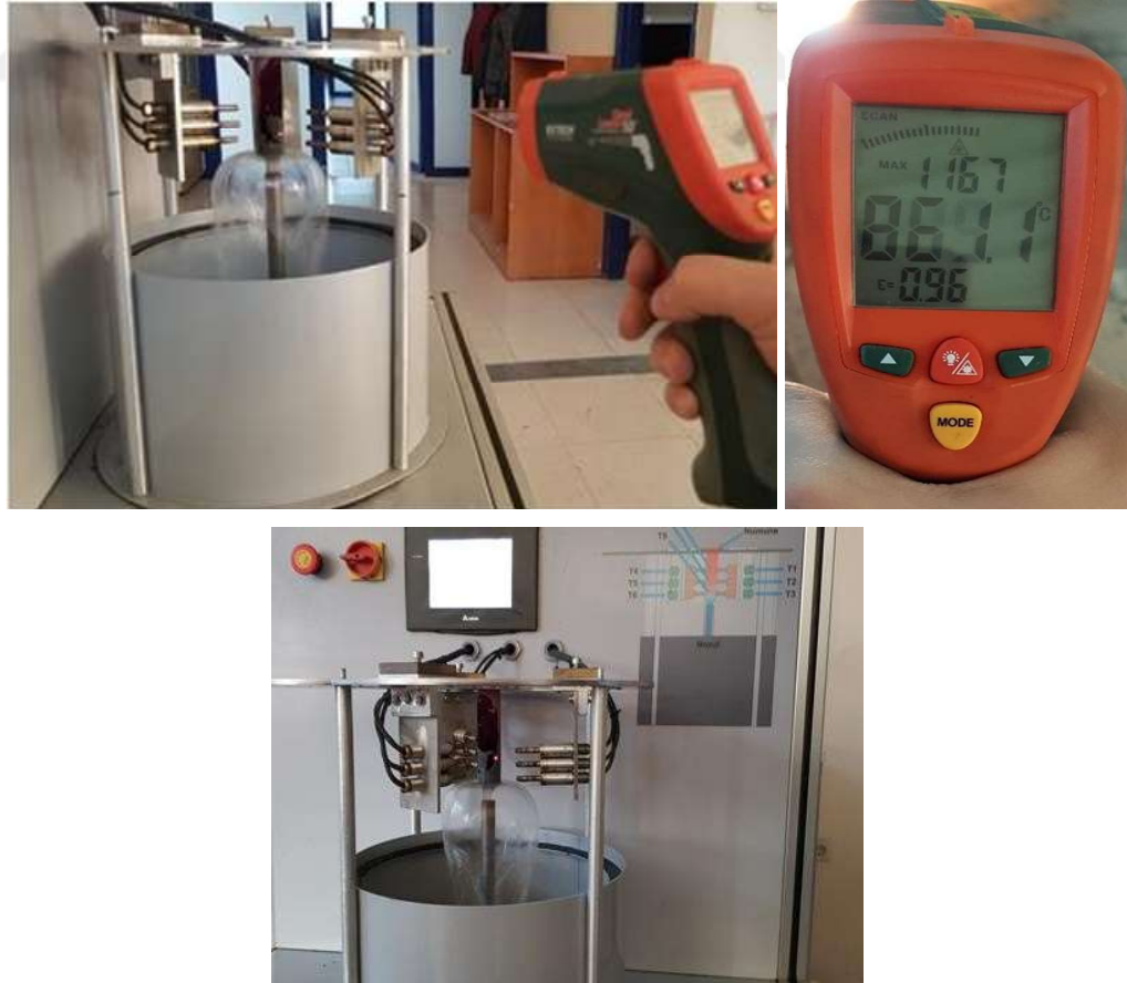
Şekil 4.8 Infrared termometre ile numune sıcaklıklarının okunması
