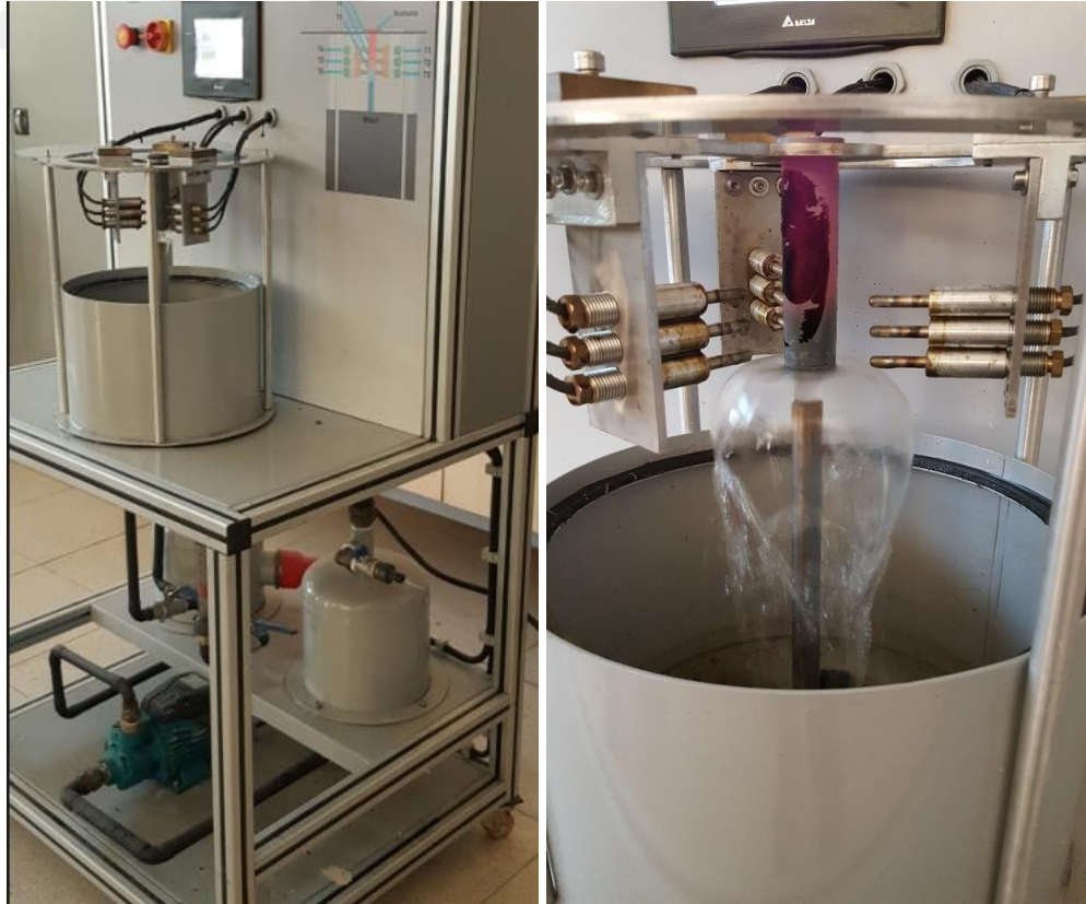
Şekil 4.1 Tasarlanıp imalatı yapılan jominy test cihazının görünümü
