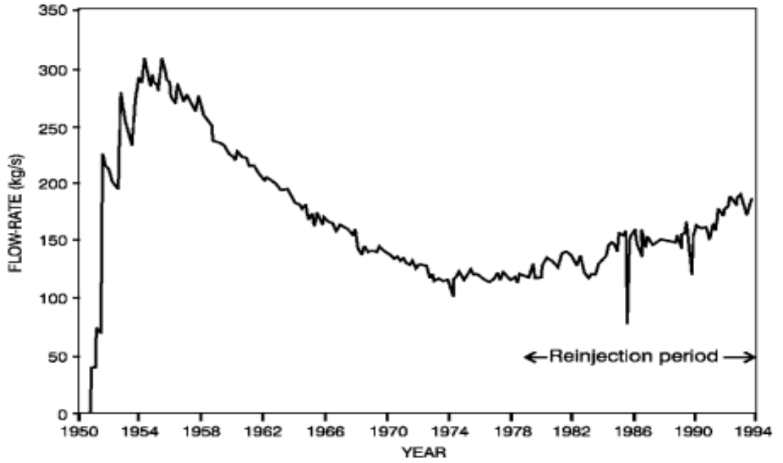
Şekil 1.20. İtalya Larderello Jeotermal Sahasında ki akış oranı (Reenjeksiyondan önce ve sonra) (Capetti vd. 1995)
