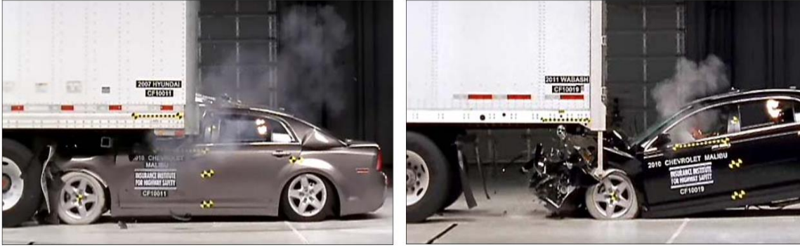
Resim 2.27. Sol tarafta %100 örtüşme ve 56 km/h çarpışma hızı ile 2007 Hyundai römorka, sağ tarafta ise %100 örtüşme ve 56 km/h çarpışma hızı ile 2011 Wabash römorka çarpma test sonuçları [38]
