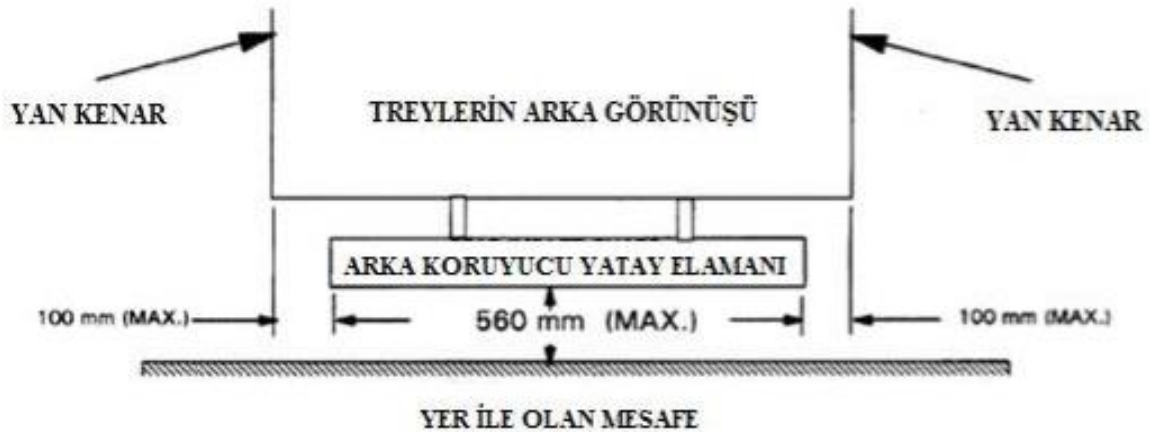
Resim 2.19. FMVSS 223 arka koruyucu yönetmeliğine ilişkin detaylar [35]
