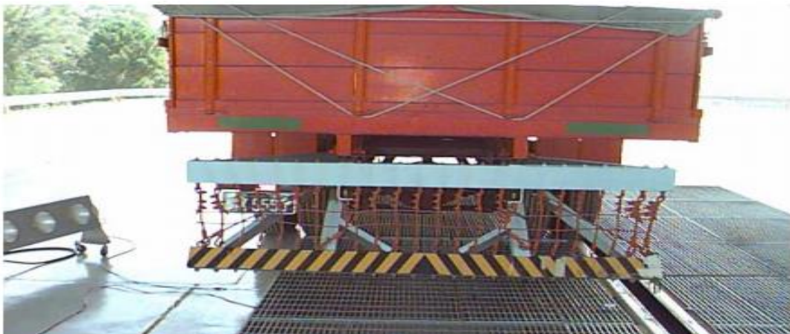
Resim 2.5. Kıskaç adı verilen arka koruyucunun çarpışma testi öncesi römorka montajı ile ilgili görüntü [14]
