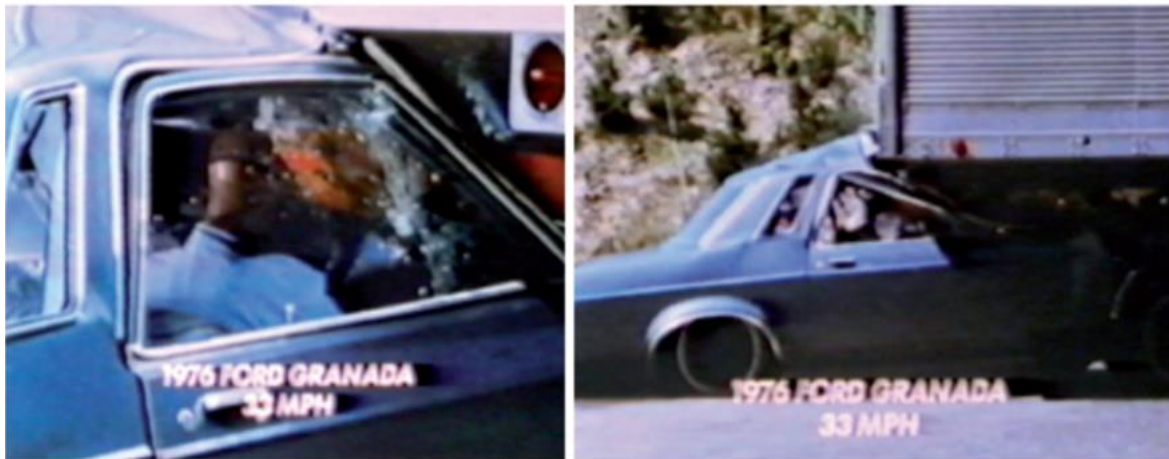
Resim 2.1. 1977 yılında IIHS tarafından yapılan 1976 model Ford Granada marka aracın 54 km/h hızla arka koruyucuya çarpma testi [9]
