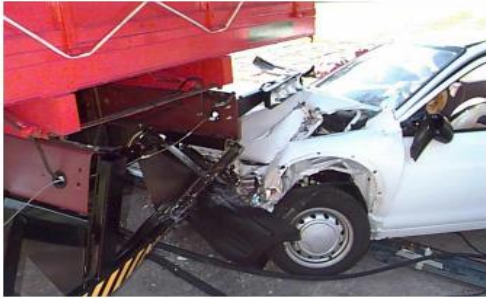
Resim 2.6. Kısaç adı verilen arka koruyucunun test sonrası görüntüleri [14]
