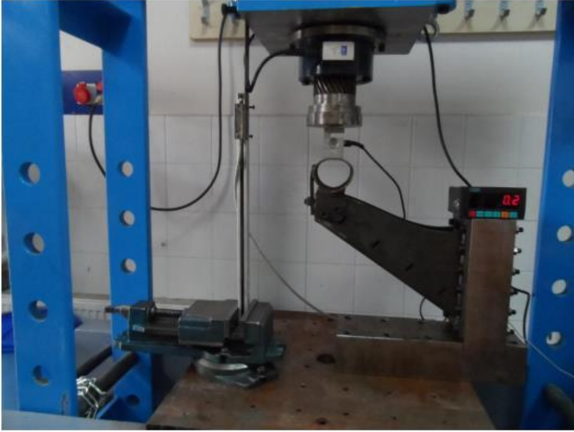
Resim 2.10. Statik yük öncesi test numunesinin yerleştirilmesi [21]
