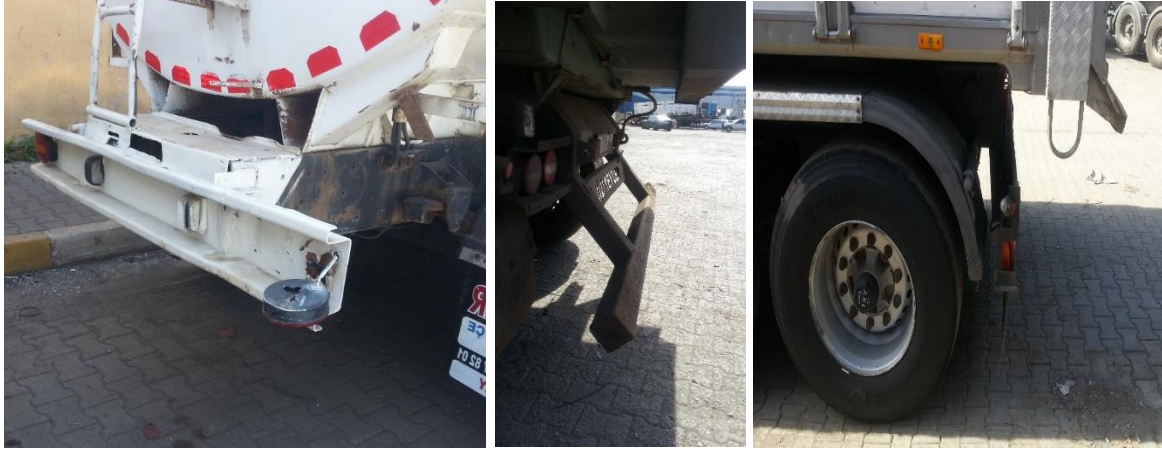
Resim 2.23. Ülkemizde uygulamada olan arka koruyucu örnekleri (a)
