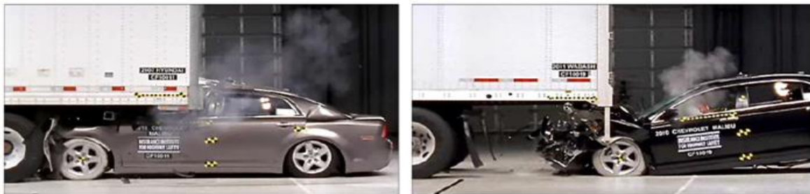
Resim 1.5. Solda 2007 Hyundai marka römork ve sağda 2011 Wabash marka römorkta 56 km/h hız ve tam örtüşme çarpışma sonucu elde edilen test sonuçları [8]
