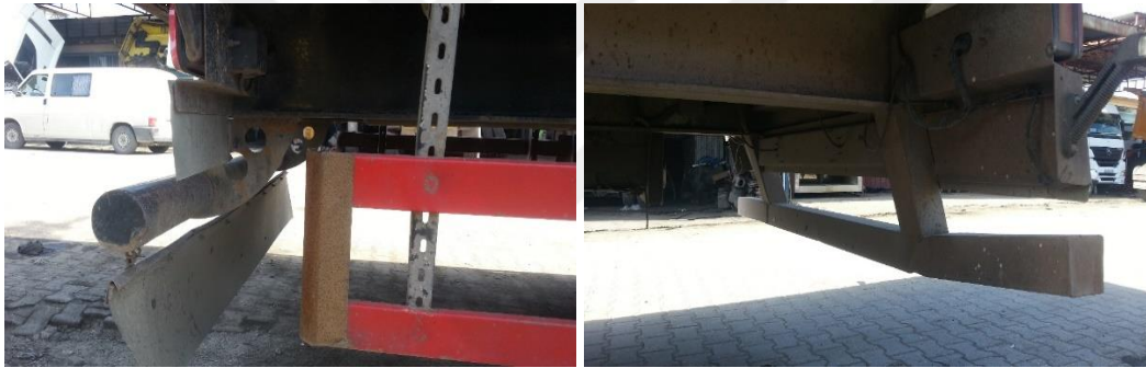
Resim 2.24. Ülkemizde uygulamada olan arka koruyucu örnekleri (b)
