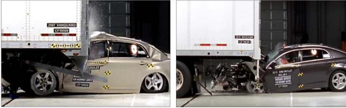
Resim 2.28. Sol tarafta %50 örtüşme ve 56 km/h çarpışma hızı ile 2007 Vanguard römorka, sağ tarafta ise %50 örtüşme ve 56 km/h çarpışma hızı ile 2011 Wabash römorka çarpma test sonuçları [38]
