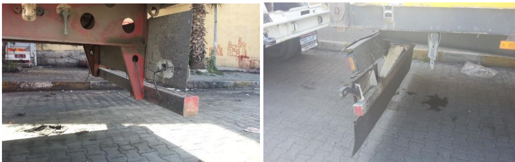
Resim 2.25. Ülkemizde uygulamada olan arka koruyucu örnekleri (c)
