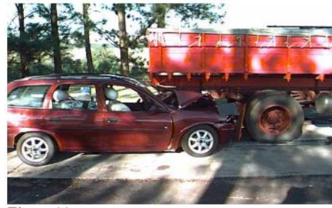
Resim 2.6. Kısaç adı verilen arka koruyucunun test sonrası görüntüleri [14]
