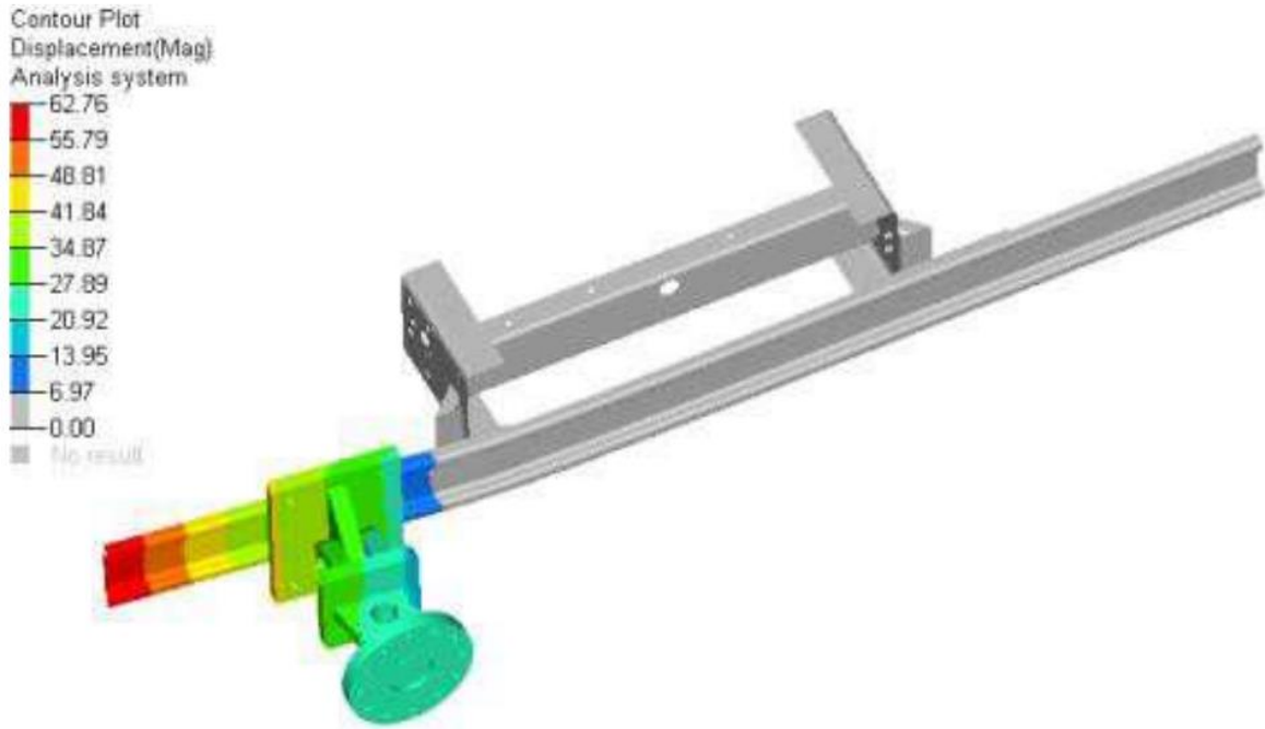
Resim 2.15. Sumit Sharma, Pawar, Patel ve Sandeep Sharma tarafından yapılan simülasyon testi sonucu maksimum yer değiştirme görüntüsü [28]
