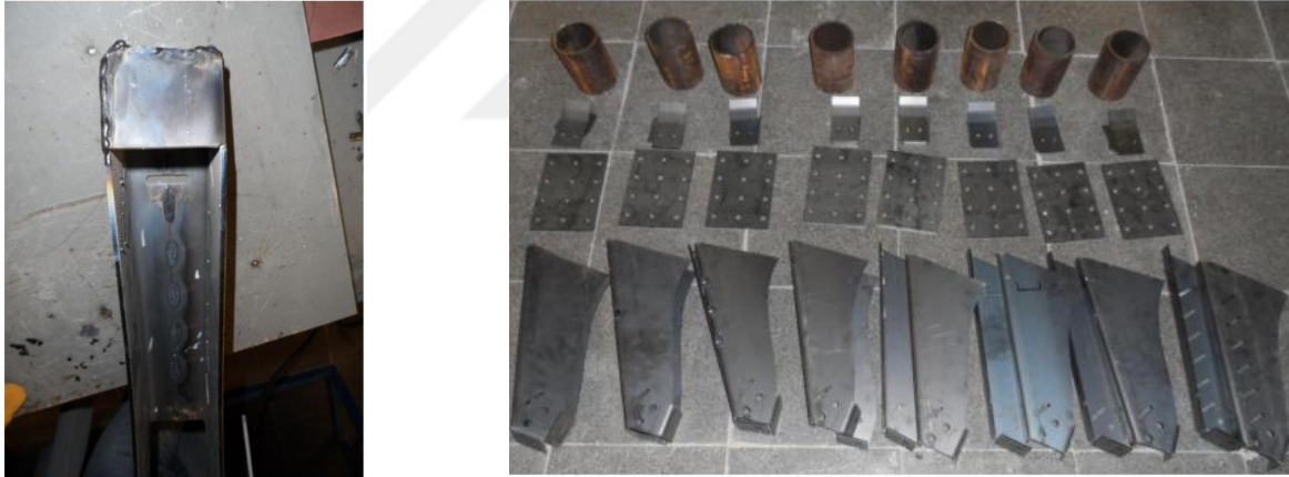
Resim 2.9. Aygün tarafından hazırlanan test numuneleri montaj öncesi (a) ve montaj sonrası (b) görüntüleri [21]
