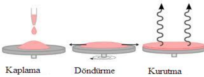
Şekil 2.3. Döndürerek kaplama yönteminin şematik gösterimi
