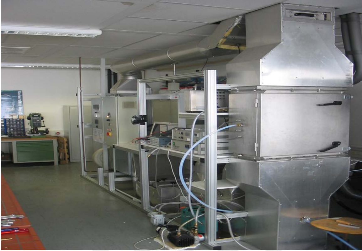
Şekil 4.14. Duisburg-Essen Üniversitesi'ndeki filtre testi standı
