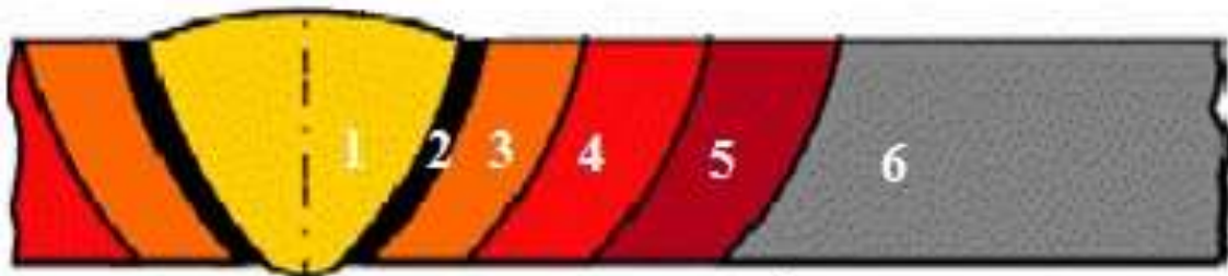
1- Kaynak metal 2- Erime çizgisi 3- İri taneli bölge 4- İnce taneli bölge 5- Kısmi dönüşmüş yapı 6- Esas metal
