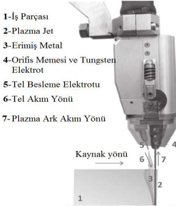
Resim 1.5. HPAK yönteminin çalışma prensibi (Yurtışık, 2013).
