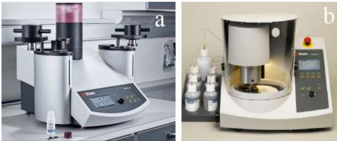
Resim 3.5. a) Struers Citopress-30 sıcak bakalite alma cihazı b) Struers Tegrami-25 zımpara makinesi
