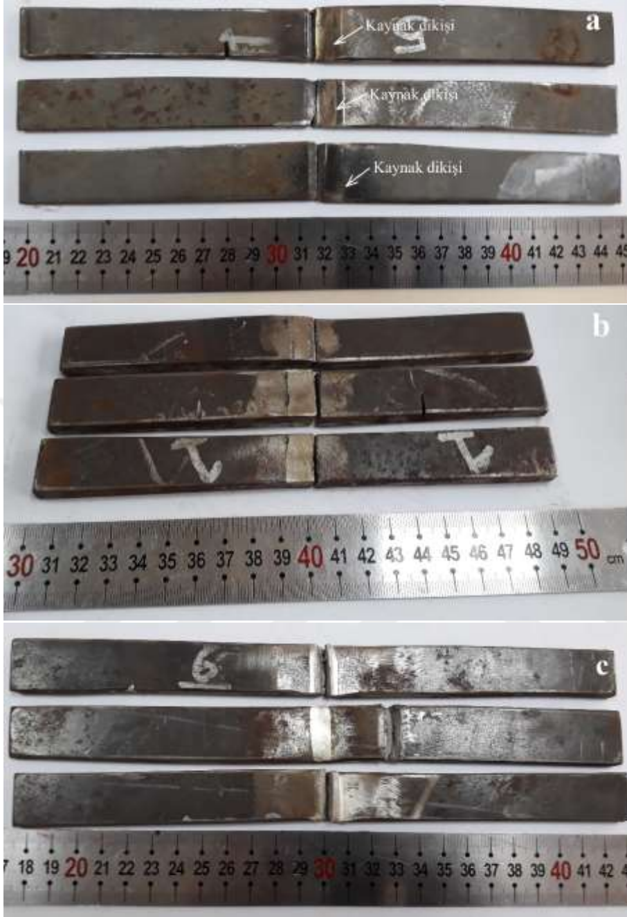
Resim 4.23. a) HPAK b) GMAK ve c) CMT kaynaklı numunelerin eğme deneyi sonrası kopma bölgelerinin görünümü
