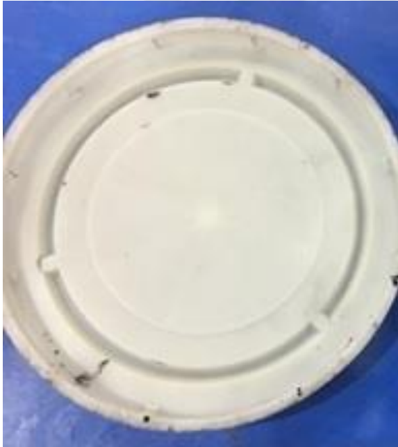
Resim 4.1. 150 kullanımdan sonra plastik kalıp
