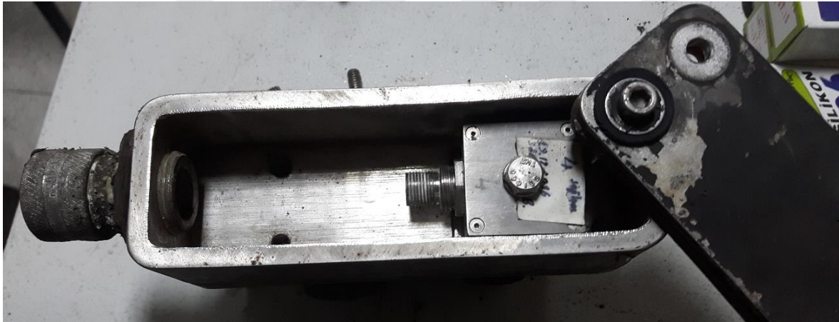
Resim 4.2. İvmeölçeri koruyucu paslanmaz çelik kutu
