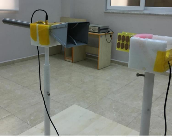
Şekil 4.2. İki boyutlu ışınma eğrisinin ölçümü için gerekli düzenek
