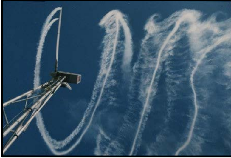
Resim 2.1. Türbin arkasında oluşan wake izi (Yılmaz, 2008)
