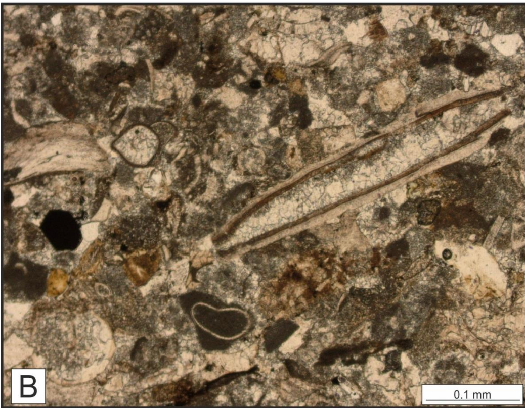
Resim 5.5. Kızıldere formasyonu kumtaşlarında görülen biyoklastların mikroskop görüntüsü; A) polarize ışık görünümü, B) normal ışık görünümü
