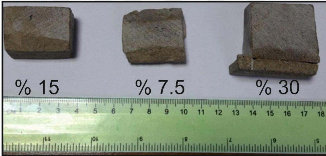
Resim 5.6. Deneyde kullanılan örnekler ve asit etki yüzeylerinin görünümü
