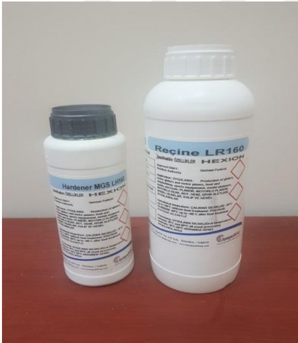
Resim 4.4. Kompozit malzeme üretiminde kullanılan epoksi reçine ve sertleştiricisi
