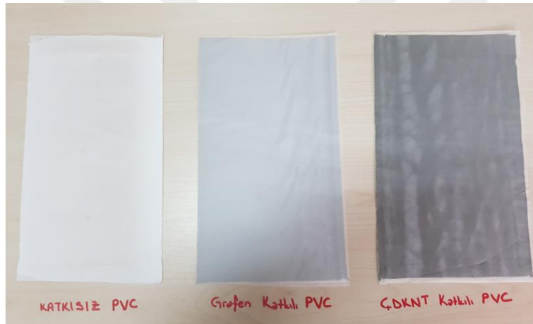
Resim 4.9.b. PVC polimerinden elde edilen nanofiberler tabakalar
