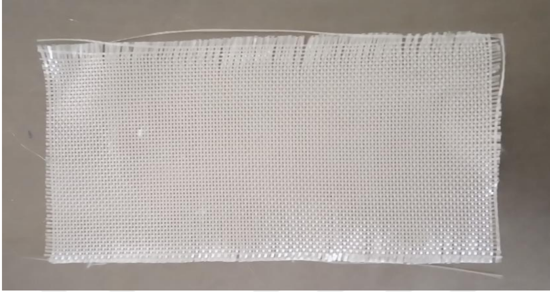
Resim 4.3. Kompozit malzeme üretiminde kullanılan cam elyaf
