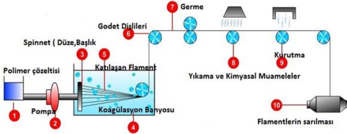
Şekil 2.13. Yaş üretim tekniğinin şematik gösterimi (Keser, 2016)
