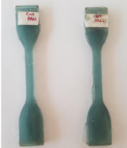
Resim 4.10-b. Köpek kemiği modeli üretilen kompozit malzeme
