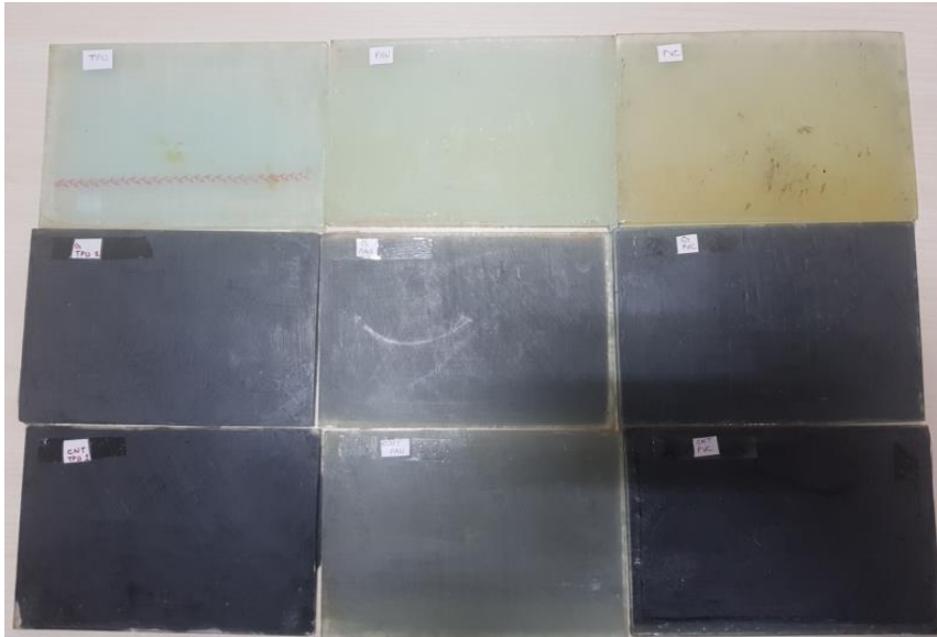
Resim 4.10-a. Düz plaka modeli üretilen kompozit malzemeler
