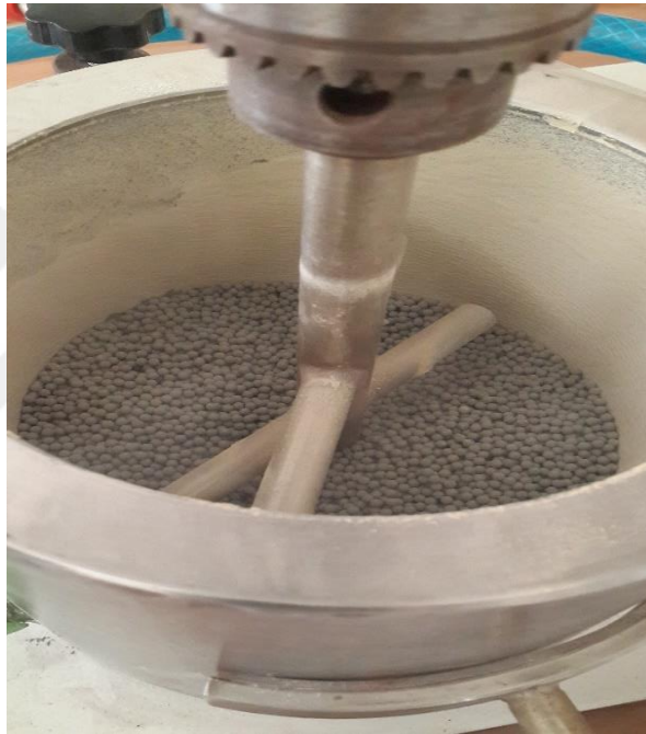
Şekil 4.4. Nanobentonit-1 öğütme işlemi sonrasında karıştırıcılı değirmen haznesi
