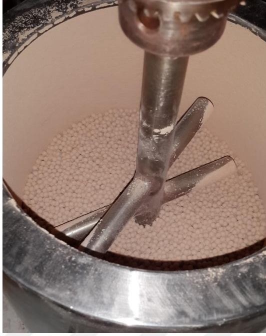
Şekil 4.5. Nanobentonit-2 için Öğütme işlemi sonrasında karıştırıcılı değirmen haznesi
