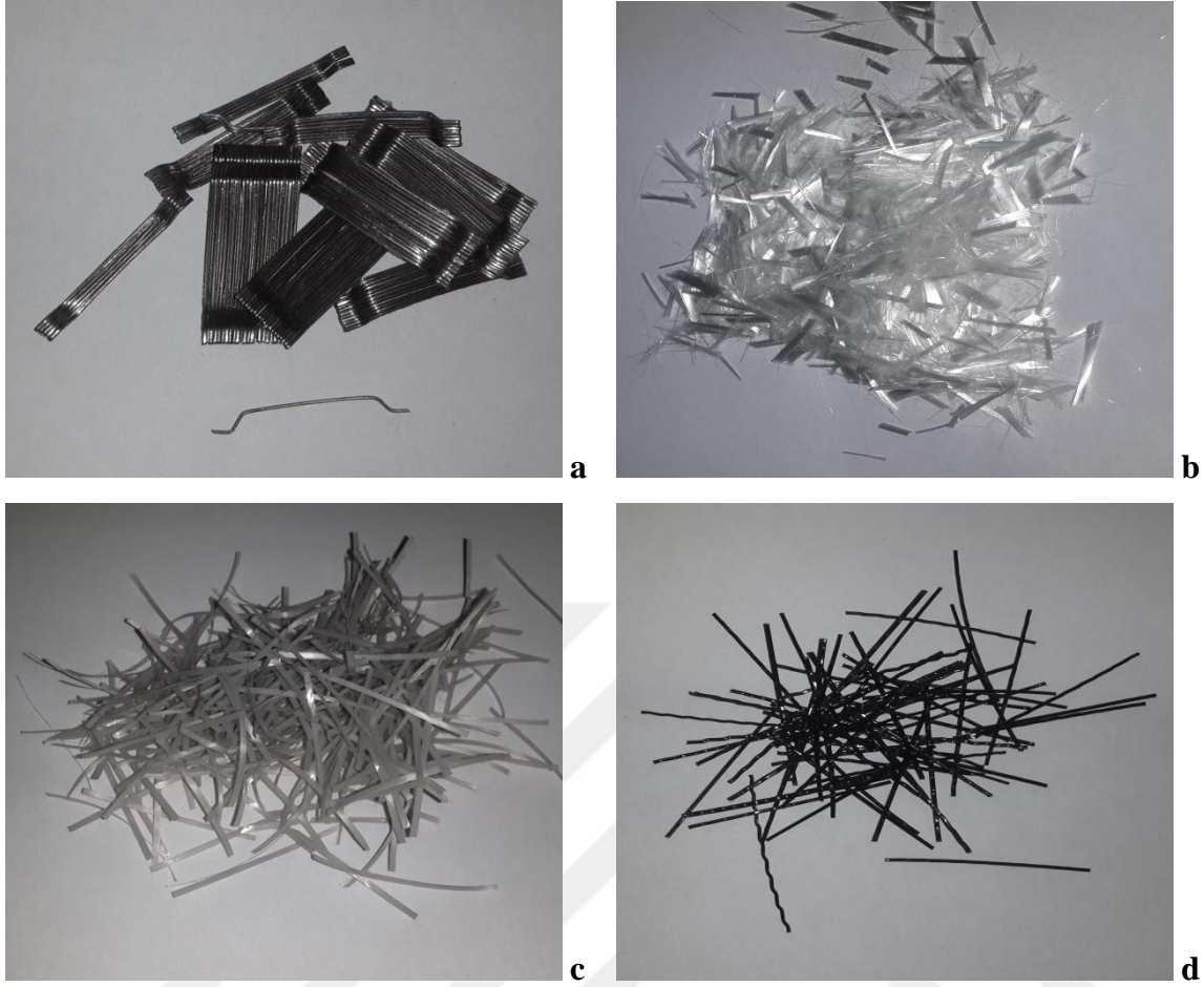
Resim 3.1. HLB üretiminde kullanılan lifler a)çelik lif b)cam elyaf lif c)sentetik lif d)polipropilen lif
