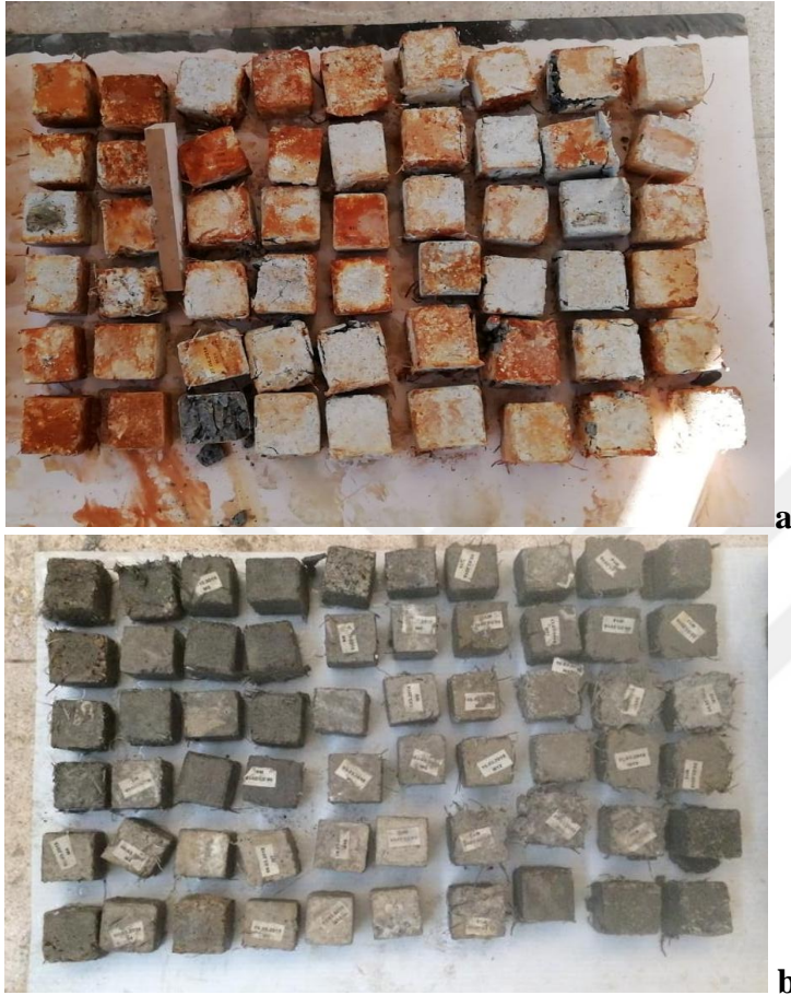
Resim 3.13. Asit ve sülfat atağından sonra HLB numuneler a) asitten sonra b) sülfattan sonra
