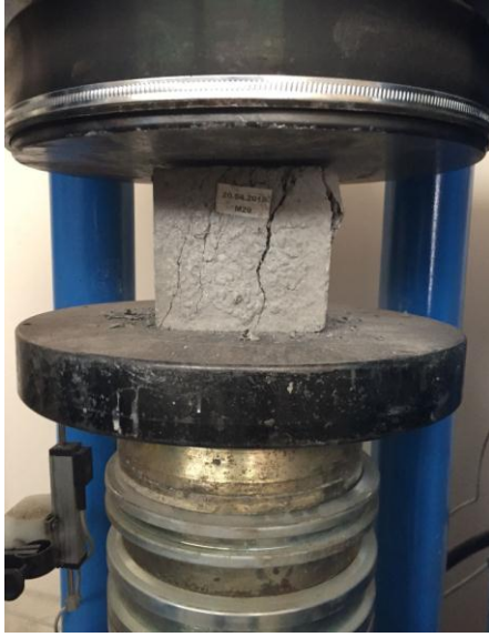
Resim 3.6. Basınç dayanımı ve deformasyon ölçüm düzeneği
