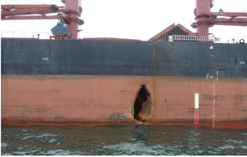
Resim 3.1. Blue Angel gemisinde kaza sonrası meydana gelen hasar (Transport Malta, 2013a).
