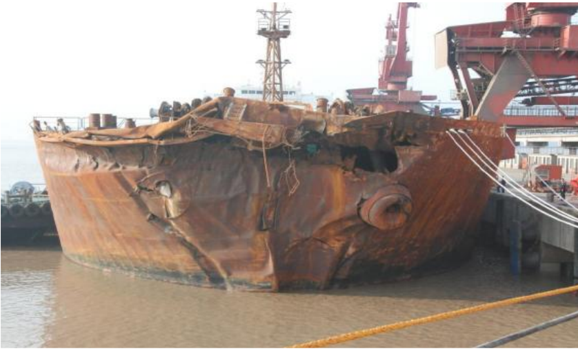
Resim 3.6. Dökme yük gemisi Cf Crystal'in baş tarafında meydana gelen hasar (MSA, 2018: 114).
