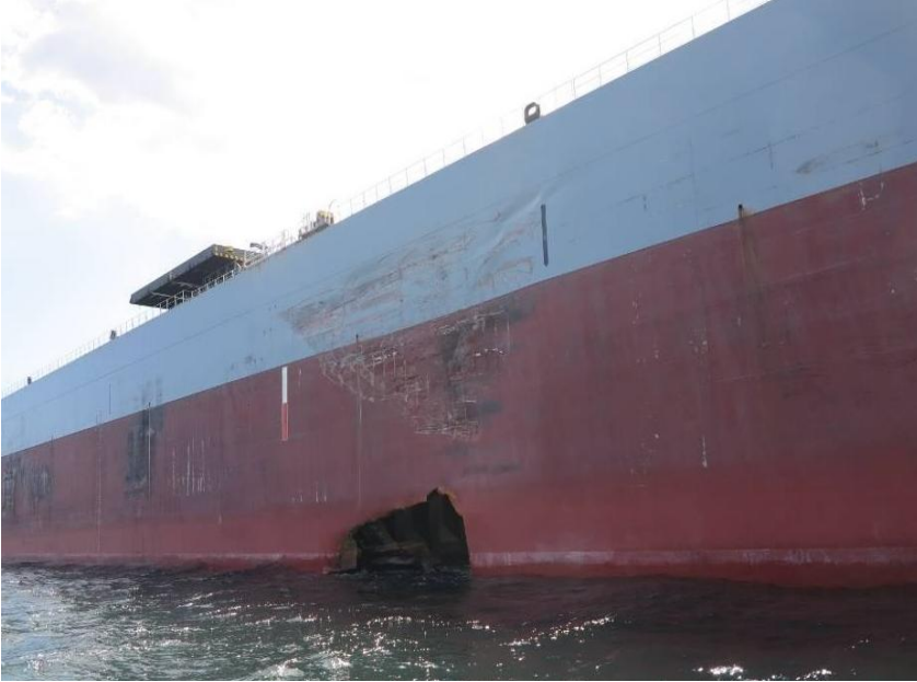
Resim 3.10. Çatışma sonrası dökme yük gemisi Cape Med'in iskele tarafında meydana gelen hasar (PMA, 2014b: 37).
