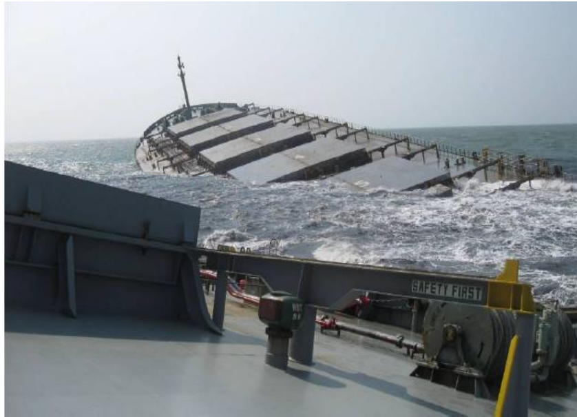
Resim 3.16. Dökme yük gemisi Smart'ın karaya oturma sonrası oluşan büyük hasar sonucu iki parçaya bölünmesi (PMA, 2014c : 38).
