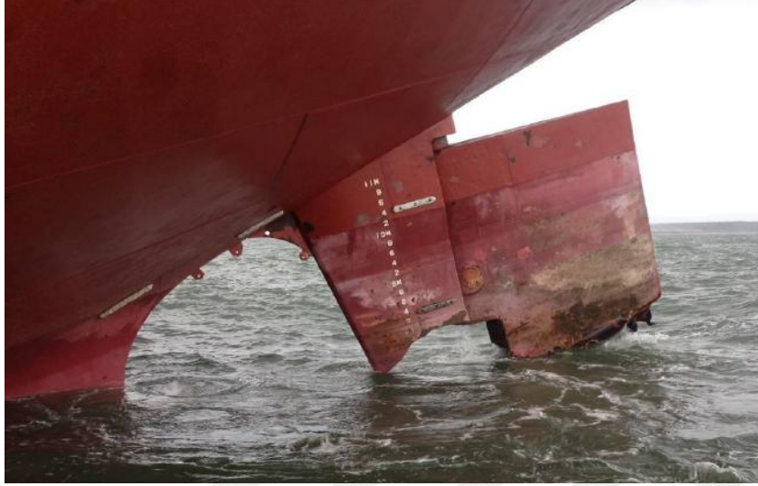
Resim 3.15. Dökme yük gemisi Smart'ın karaya oturma sonrası meydana gelen dümen kaybı (PMA, 2014c : 35).
