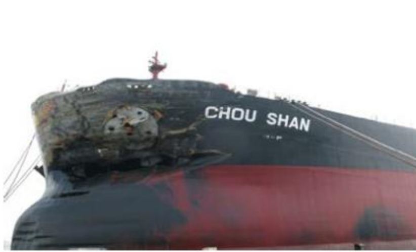
Resim 3.3. Çatışma sonrası dökme yük gemisi Chou Shan'da meydana gelen hasar (MSA, 2014: 18).
