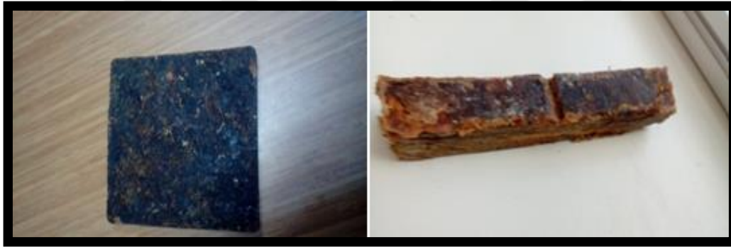
Şekil 3.16. Çentik darbe testi numunesinin oluşturulduğu kare plaka ve çentik darbe testi numunesi
