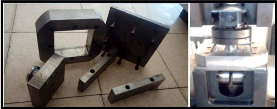
Şekil 3.4. Kare plaka üretim kalıbı parçaları ve basım işleminin gerçekleştirilme süreci
