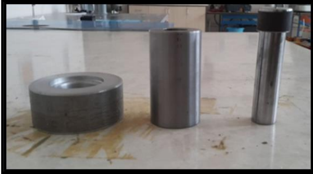
Şekil 3.6. Silindirik numune üretim kalıbı
