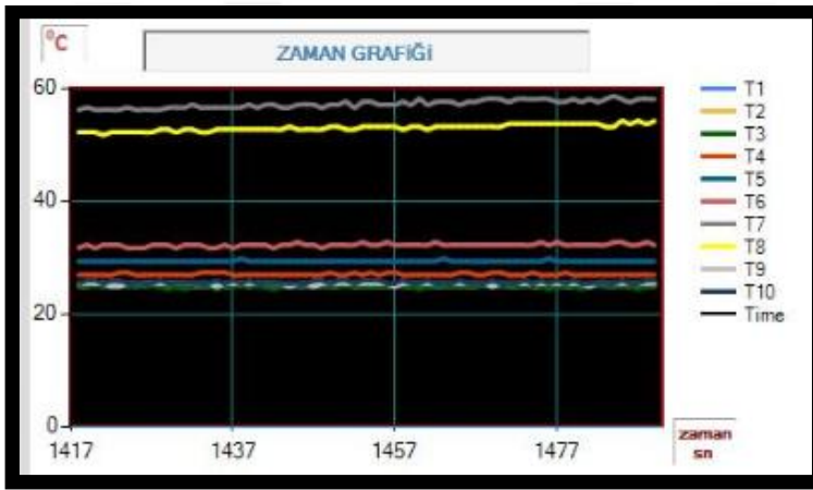
Şekil 3.14. Portakal posası ile hazırlanmış ısı numunesi için ısııl denge zaman grafiği
