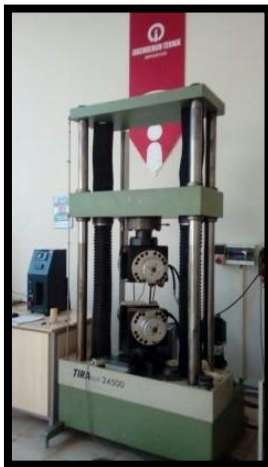
Şekil 3.3. 50 ton kapasiteli presleme tezgâhı
