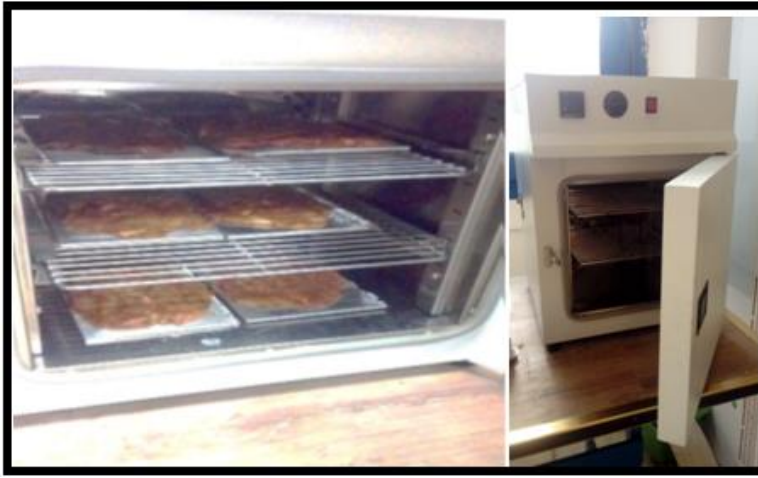
Şekil 3.2. Kurutma fırını ve kurutma işleminin uygulaması
