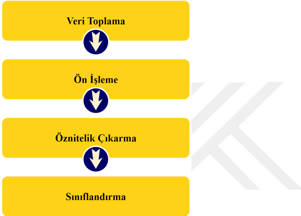
Şekil 3.1. Örüntü tanıma sistemlerinde temel işlemler
