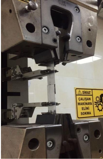
Resim 3.12. Numunelere uygulanan çekme testi
