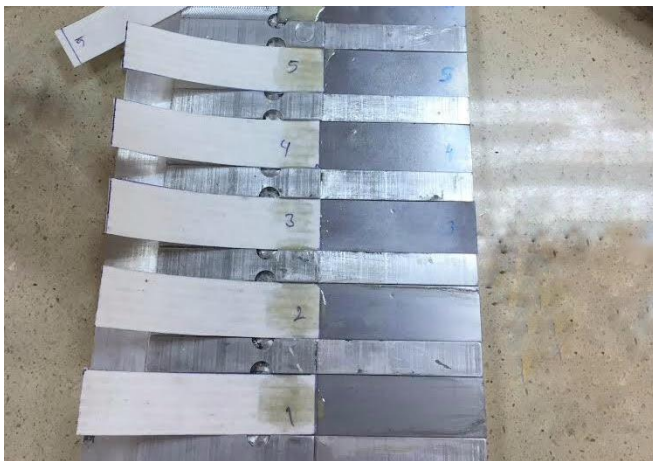
Resim 3.10. Yapıştırıcı uygulanan kalıp içerisindeki filtre kağıdı-metal numuneleri
