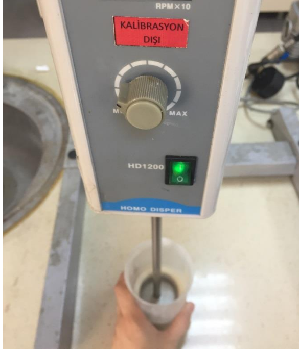
Resim 3.8. Karışımın mikser ile karıştırılarak homojen haline getirilmesi işlemi
