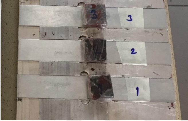
Resim 3.11. Yapıştırıcı uygulanan kalıp içerisindeki metal-metal numuneleri
