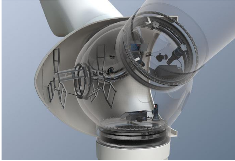
Şekil 3.6. Modern bir rotor göbeğinin iç yapısı
