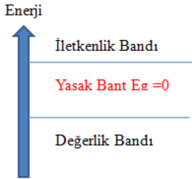
Şekil 2.10: İletken malzemeler için enerji bandının şematik gösterimi
