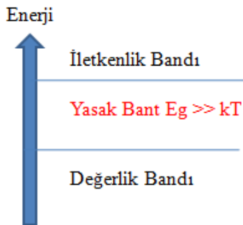
Şekil 2.11: Yalıtkan malzemeler için enerji bandının şematik gösterimi
