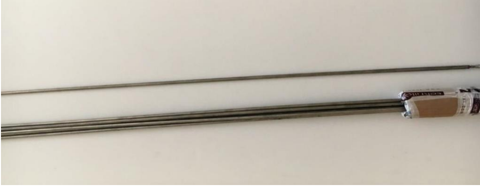
Resim 2.10. Fırın ısıtmasında kullanılan boru tip incoloy800 rezistans
