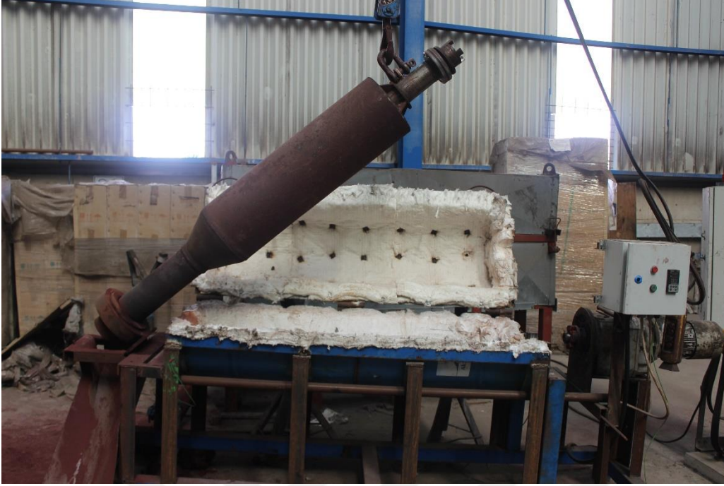
Resim 2.13. Tambur tahliye konumundayken fırının görüntüsü
