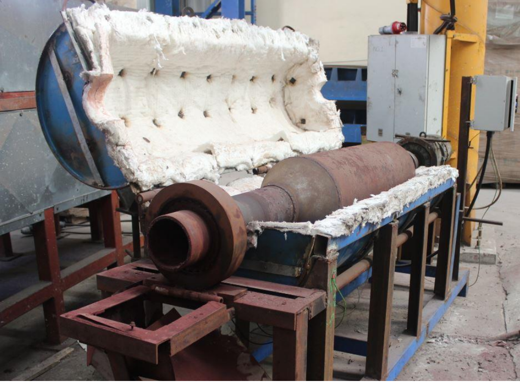
Resim 2.12. Tambur yatay konumundayken fırının görüntüsü
