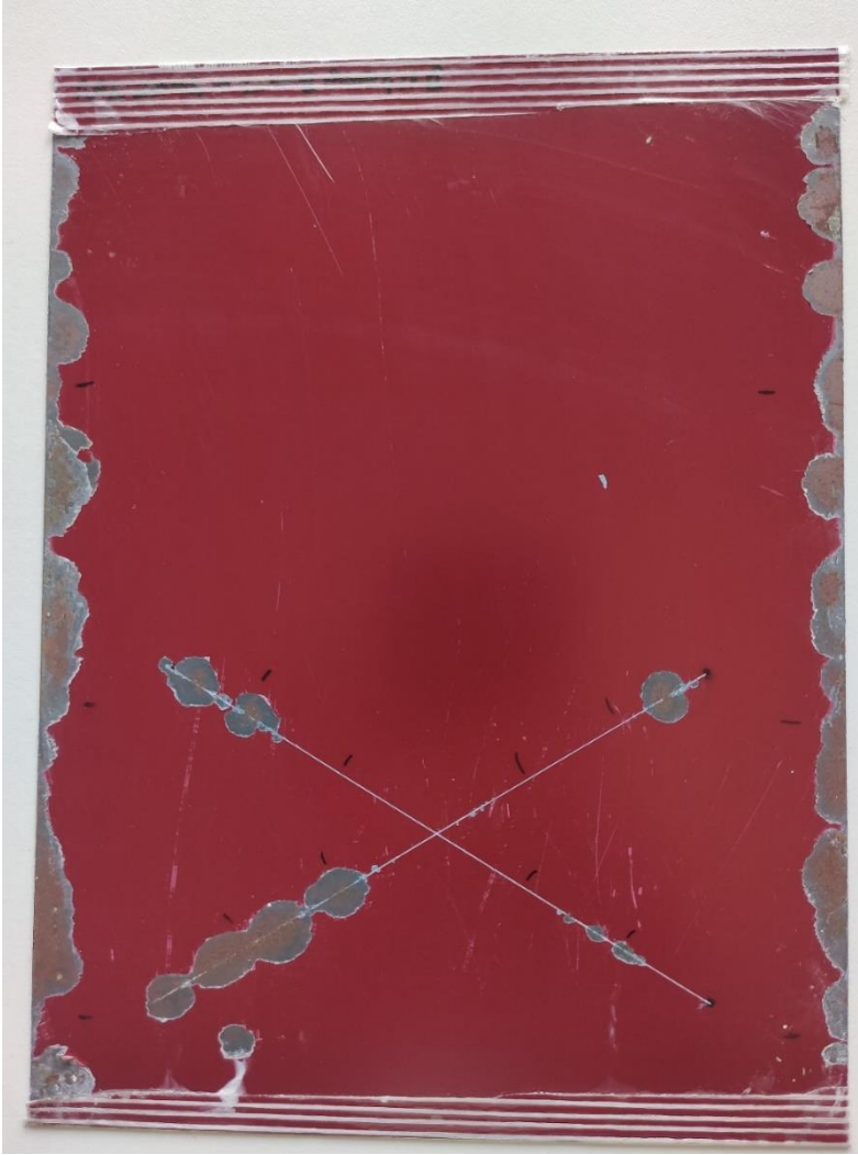
Resim 3.16. 500 saat NTSST uygulanmış test paneli
