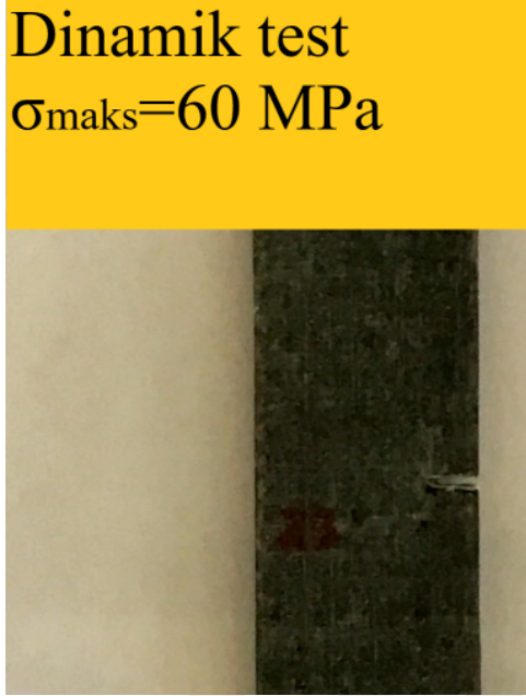
Resim 7.16. Azami gerilmesi 60 MPa olan yorulma testinde 780 500 yük çevrimine tabi tutulmuş numune
