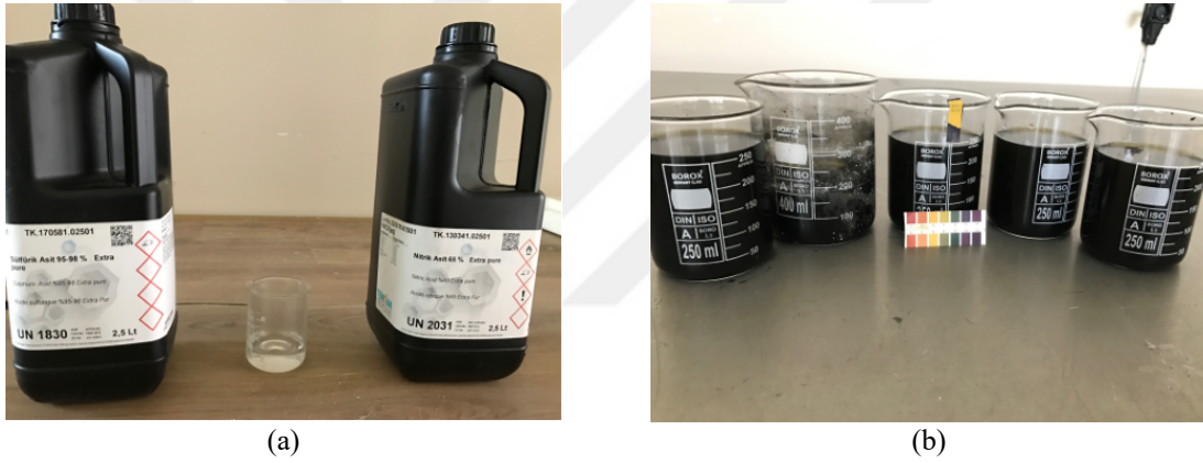
Resim 6.8. a) Sulfirik ve nitrik asidin 1:1 oranında karıştırılması, b) KNT'lerin asit ile saflaştırılması sonrası saf suyla nötralizasyon işlemi
