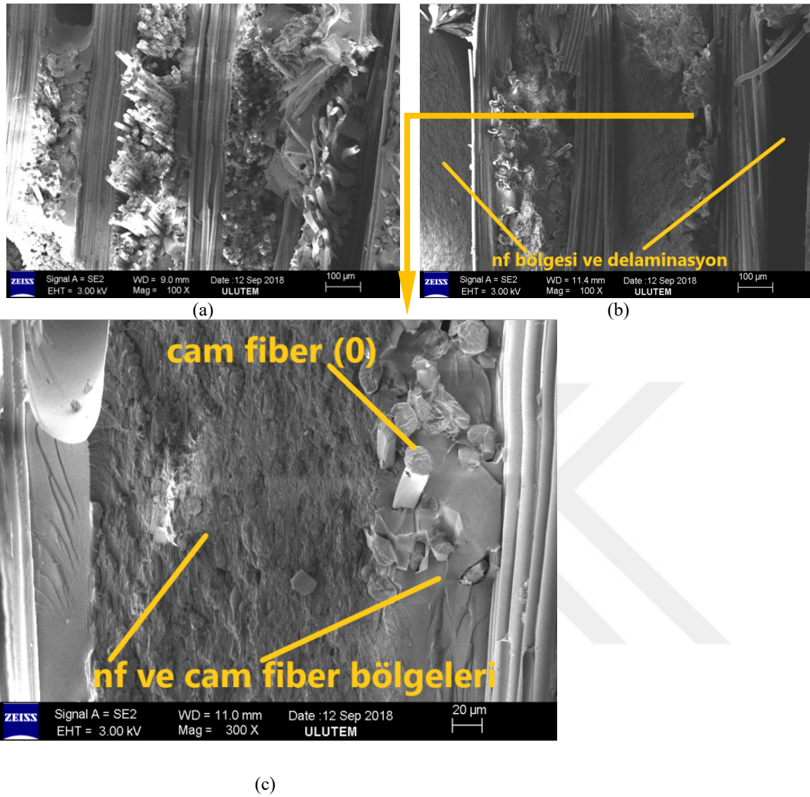
Resim 7.7. a) Referans ( R ), b) ve c) nano elyaf-takviyeli ( R+NF ) kompozitlerin SEM görünümü
