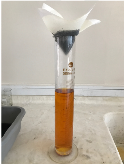
Resim 6.10. Beş gün 120°C'de amin ile fonksiyonelleştirilen KNT'lerin ayrıştırılması
