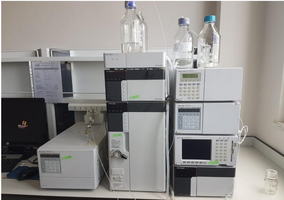
Resim 3.7. R. miraletus mukusunda bulunan \alpha - tokoferol miktarının tespit edildiği HPLC cihazı
