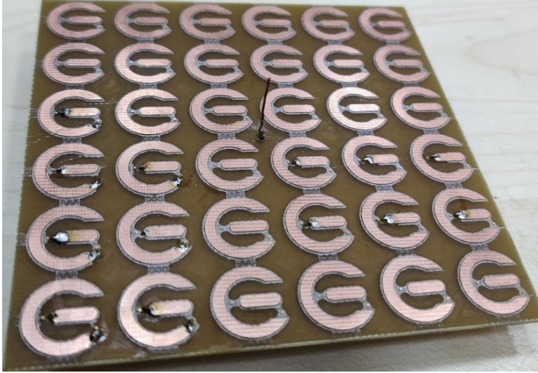
Resim 4.3. İkinci metayüzey yapısının birinci konfigürasyonunun üretilmiş görseli
