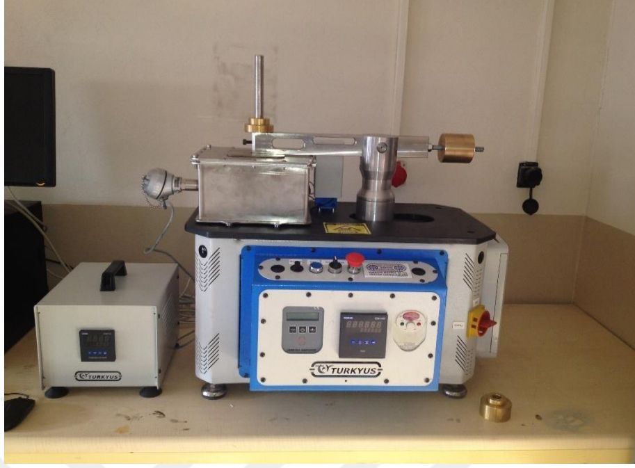
Şekil 3.7. Turkyus yüksek sıcaklık ball-on disk aşınma cihazı
