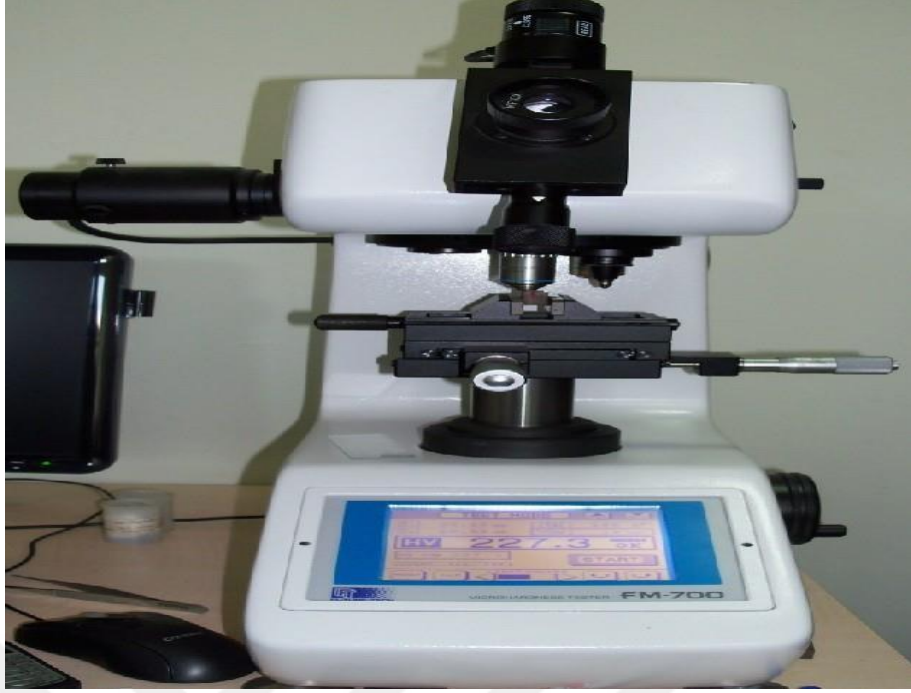
Şekil 3.5. Future Tech FM-700 Mikrosertlik ölçüm cihazının görüntüsü
