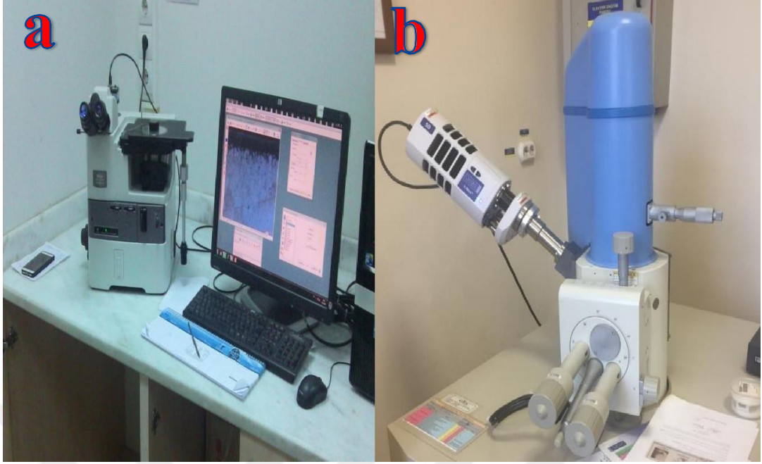
Şekil 3.4. a) Nikon MA 200 ters metal mikroskobu b) OXORD X-MAX marka SEM cihazının görünümü
