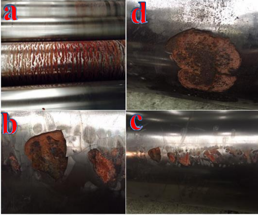
Şekil 1. 10. a) Korozyon Başlangıcı b) Ani darbe sonucu kaplama tabakasının kalkması c) Darbe ve termal genleşme sonucu roll'ün diğer bölgelerinde kaplama atması d) Kaplamanın tamamen düşerek roll'ün kullanılmaz duruma gelmesi.
