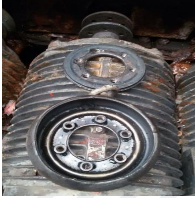
Şekil 1. 12. Roll de oluşan salğı sonrasında lastik kaplin hasarı
