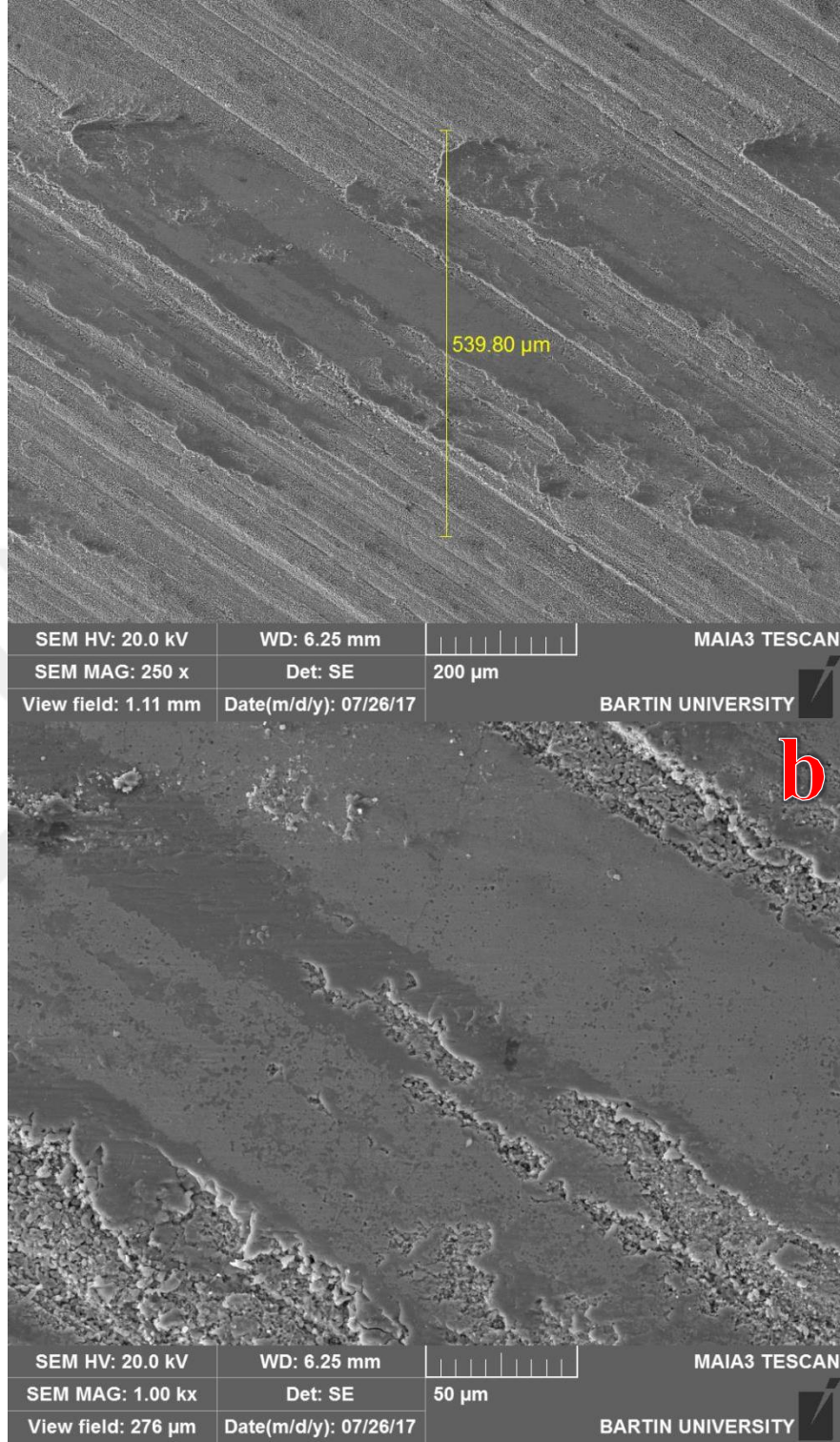
Şekil 4.23. Borlama işlemine tabi tutulan STKM-13A çeliğinin 3 N yük ve 250 °C sıcaklığında kuru-kayma aşınma deney sonrası SEM yüzey görünümü
