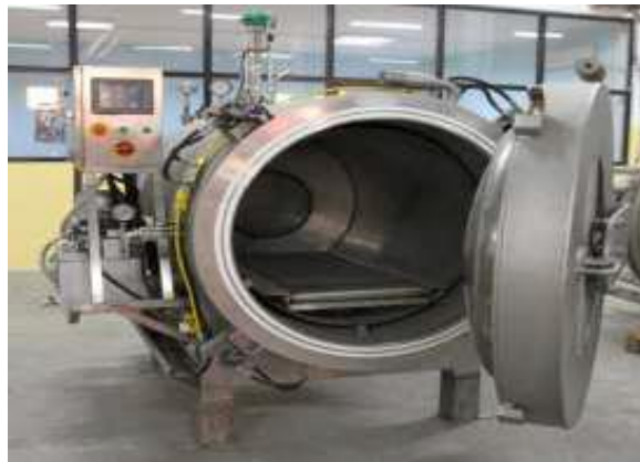
Şekil 2. 1. Kriyojenik işlemin yapıldığı azot tankı görünümü (Uzun, 2014)
