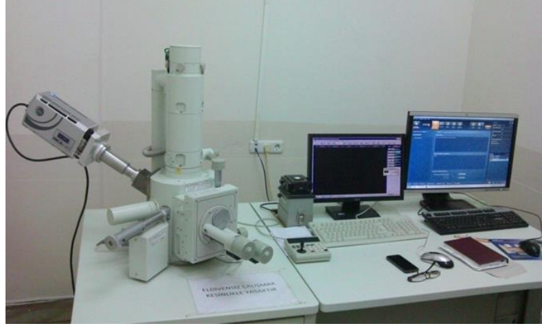
Şekil 3. 8. JEOL JSM-5600 marka SEM cihazı
