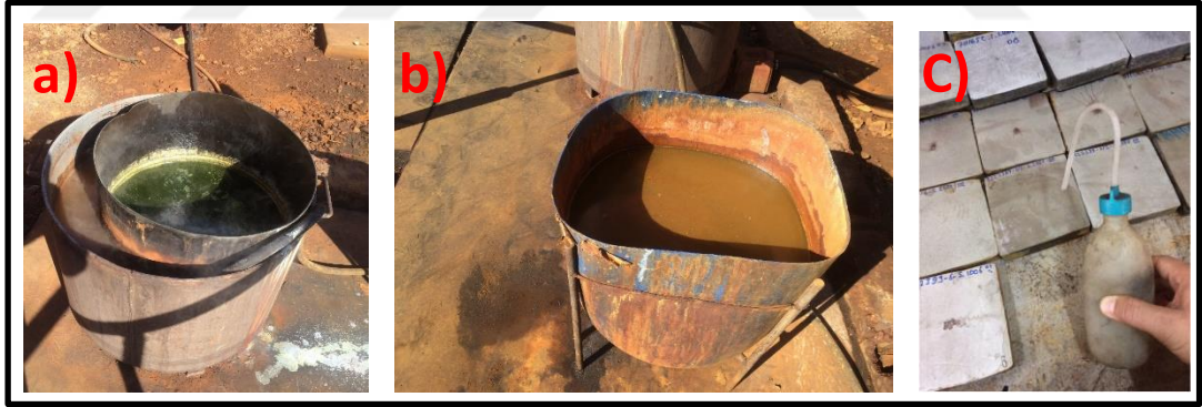
Şekil 3.17. a) Asit tankı b) durulama tankı c) yüzey temizliği
