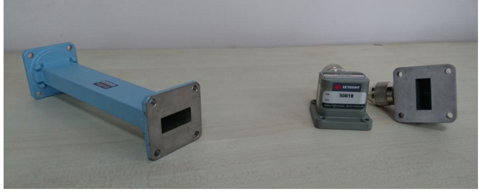
Şekil 4.31. Ölçümde kullanılan 22.86mm-10.16mm X-band dalga kılavuzu (a) ve adaptör (b)
