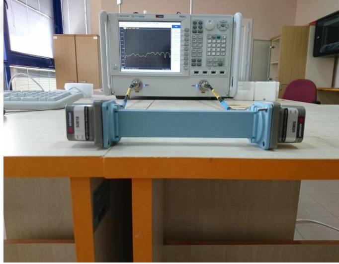
Şekil 4.20. Dairesel halka rezonatörlü sensöre ait dalga kılavuzu ölçüm düzeneği
