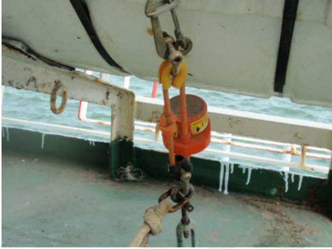
Resim 3.1. Yanlış yapılmış hidrostatik kilit bağlantısı [143].
