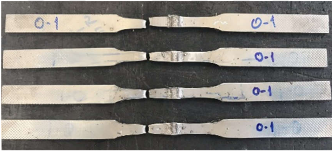
Şekil 4.9. Düşük ısı girdili kaynaklı bağlantıdan çıkarılan çekme numunelerinin deney sonrası kırılmanın baz plaka içerisinde gerçekleştiğini gösteren makro resimler
