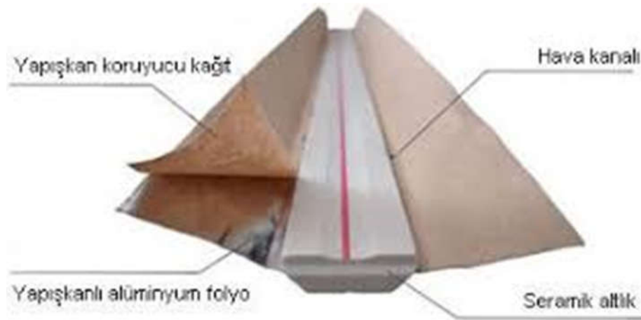
Şekil 3.2. Çalışmada kullanılan seramik altlık
