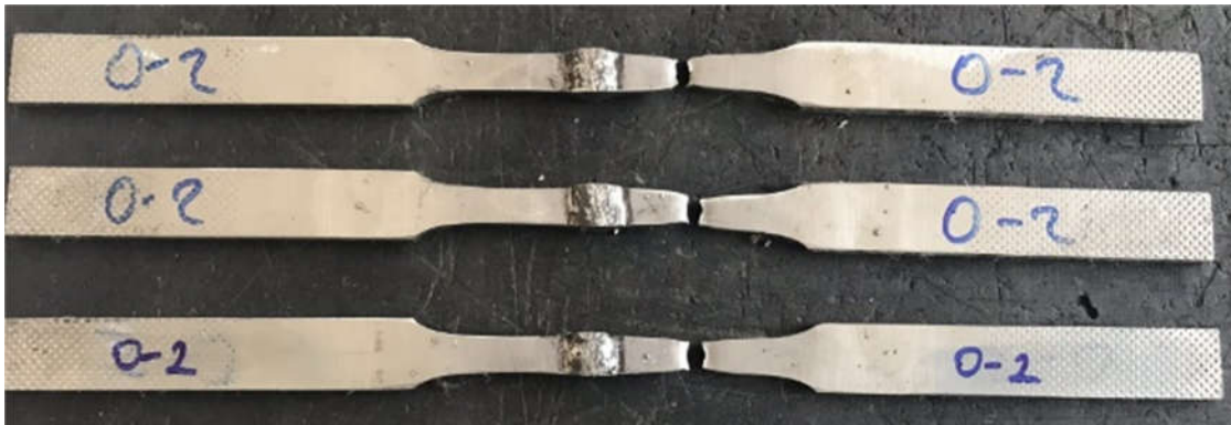
Şekil 4.10. Yüksek ısı girdili kaynaklı bağlantıdan çıkarılan çekme numunelerinin deney sonrası kırılmanın baz plaka içerisinde gerçekleştiğini gösteren makro resimler
